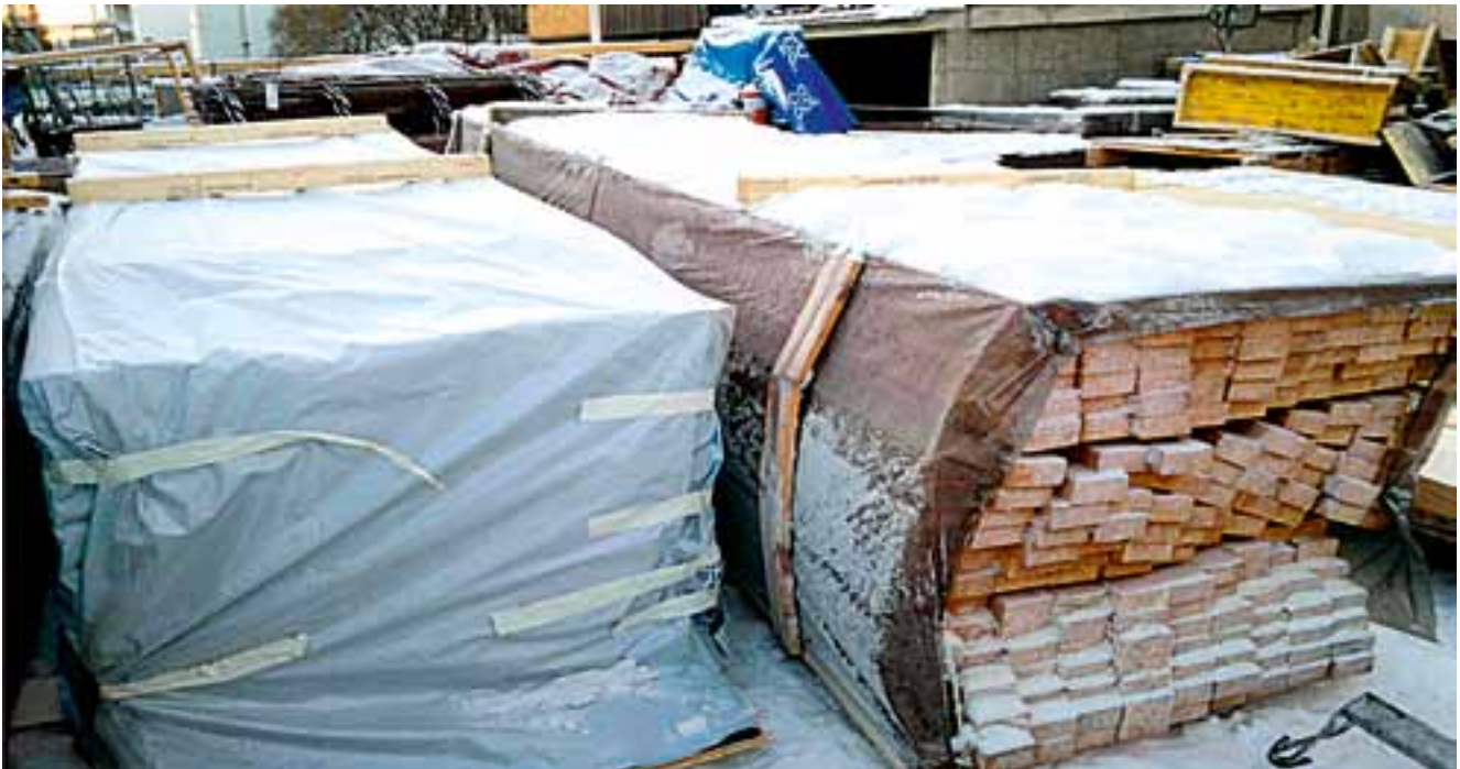
Kuva 7. Kuorman oikealla puolella oli alimpana osittain hajonnut puutavaraniippu.
