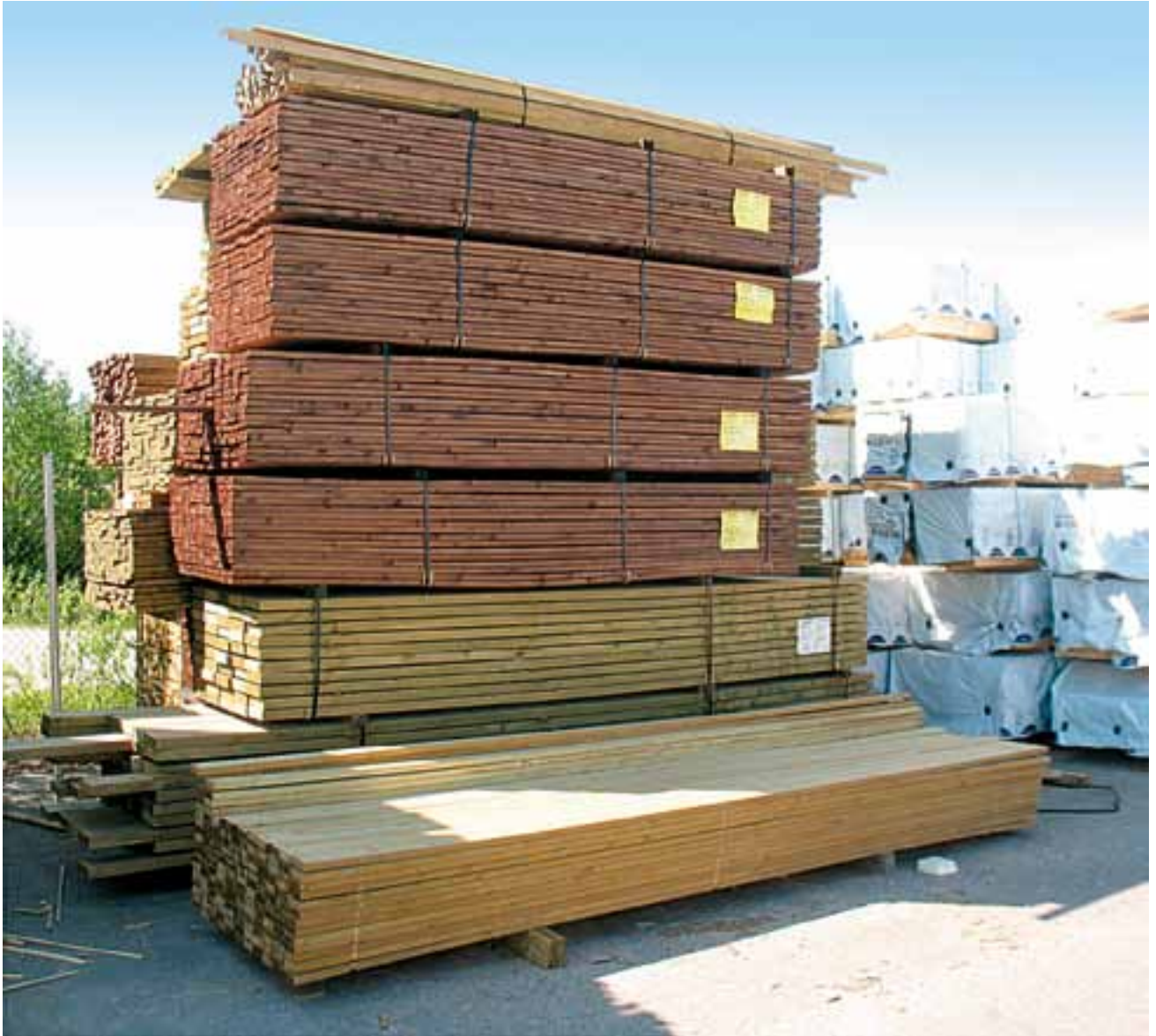
Kuva 2. Puutavaraniiput voivat olla jopa seitsemän nipun korkuisia.
