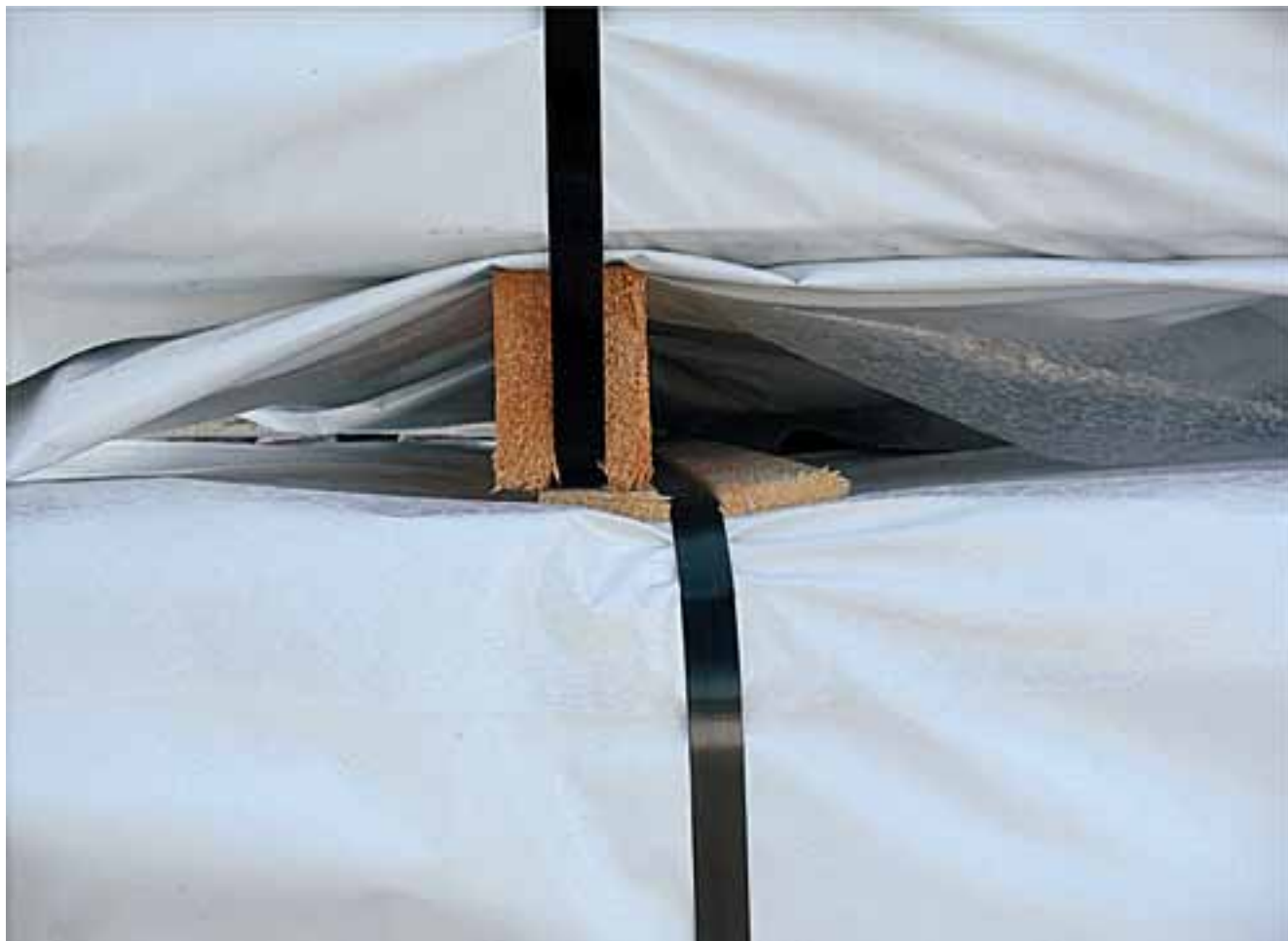
Kuva 8. Aluspuut on kiinnitetty puutavaraniippuihin valmiiksi jo sahalla.
