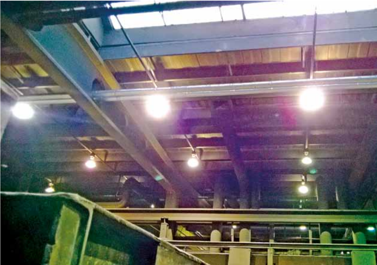
Kuva 3. Ylöspäin katsottaessa katossa olevat valot aiheuttavat voimakkaan kontrastin hämärässä ympäristössä. NN:n käyttämän hengityssuojaimen visiiri ja erityisesti sen naarmuinen yläosa heikensivät muutenkin huonoa näkyvyyttä.
