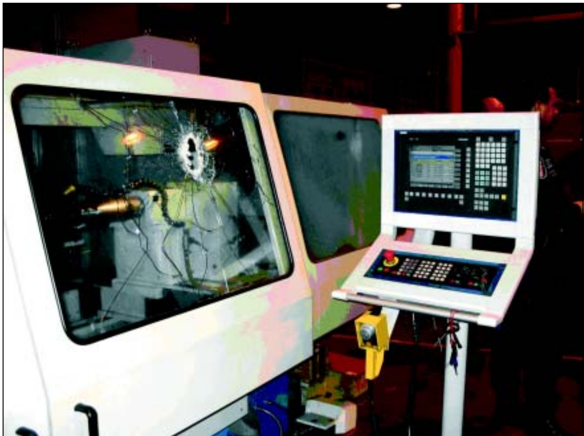
Kuva 1. Kuvassa näkyy hiomakone ja reikä, jonka hiomakiven kappale teki suojalasiin.
