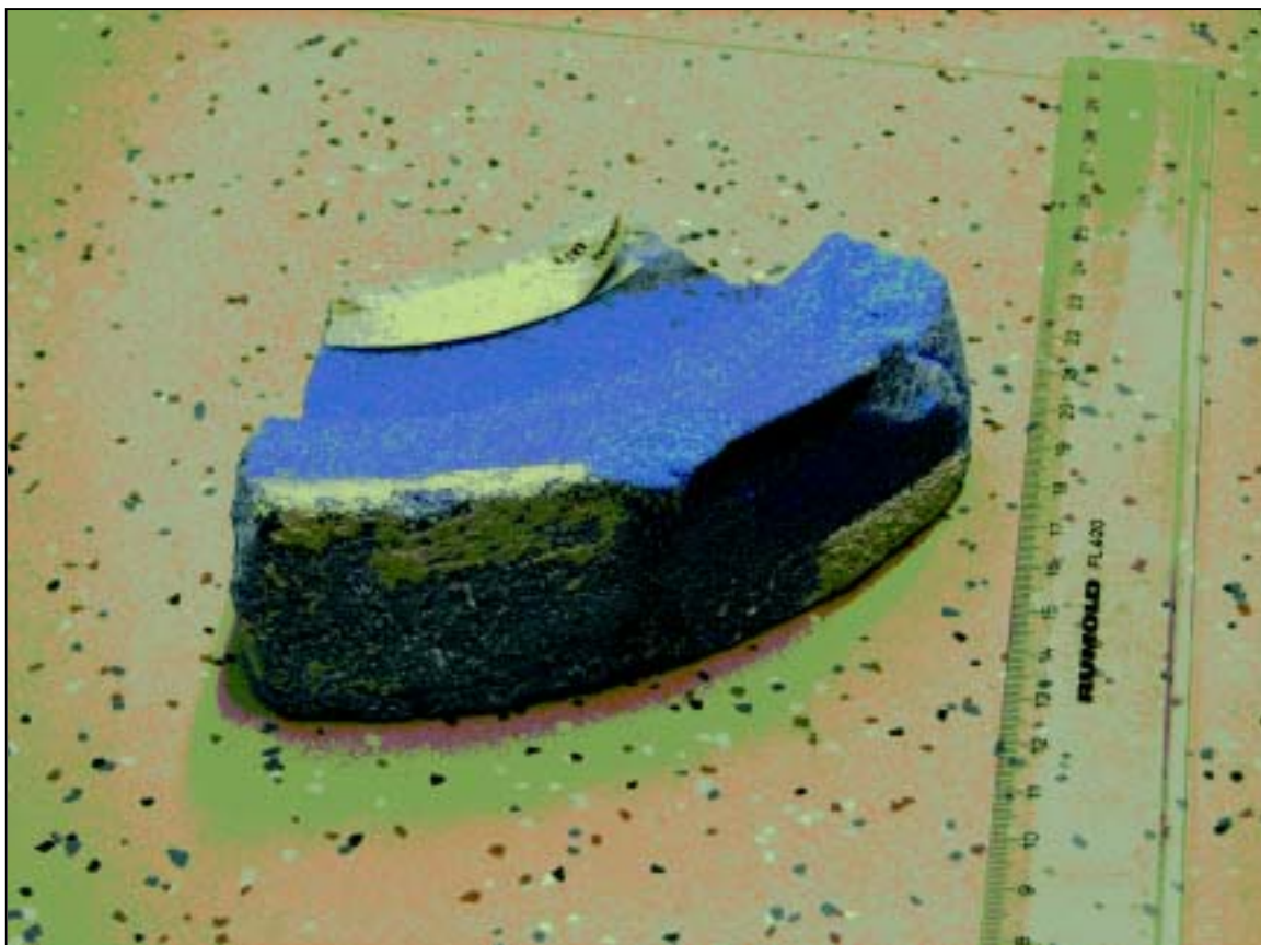
Kuva 5. Tapaturman aiheuttanut hiomakiven palanen. Kivestä on osumien jälkeen lähtenyt palasia. Kiven reunalla näkyvät vaaleat osat ovat ilmeisesti voimakkaasta katto-osumasta kiinni jäänyttä laastia. Hiontapinnan yläreunassa näkyvä tumma osa viittaa siihen, että kiveä on hieman käytetty.
