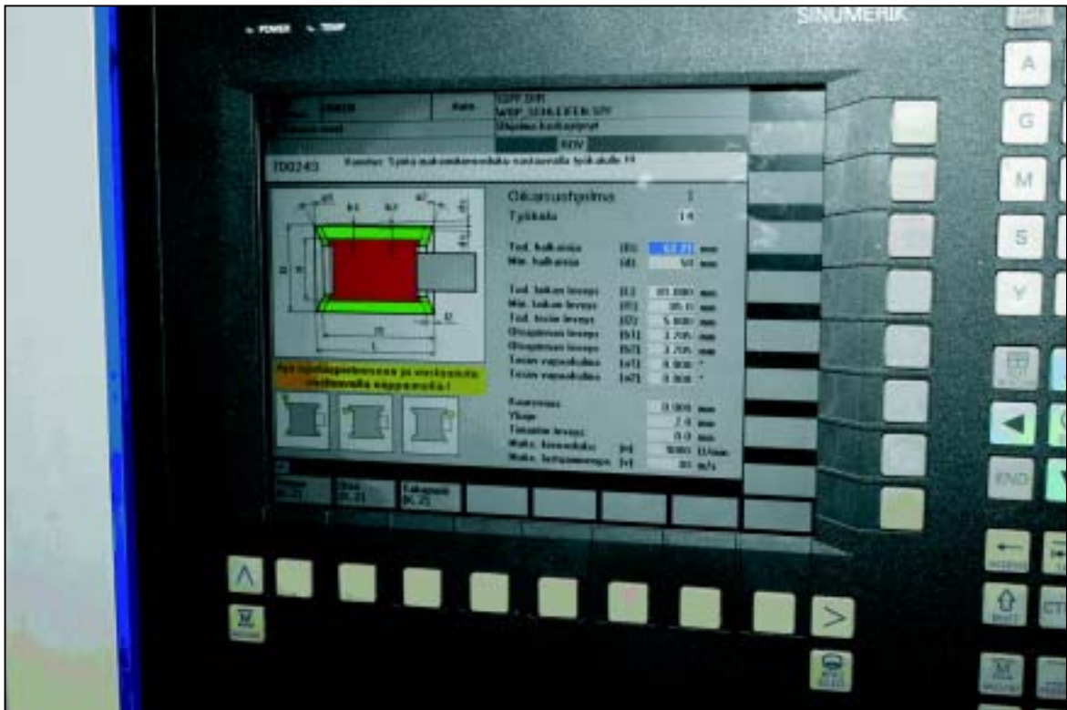
Kuva 4. Kuvanäytössä näkyy ohjelmoitavan hiomakiven koko. Kivikuvan yläpuolella on myös teksti: "Varoitus. Syötä maksimikierto- ja välikohdan leveys!"
