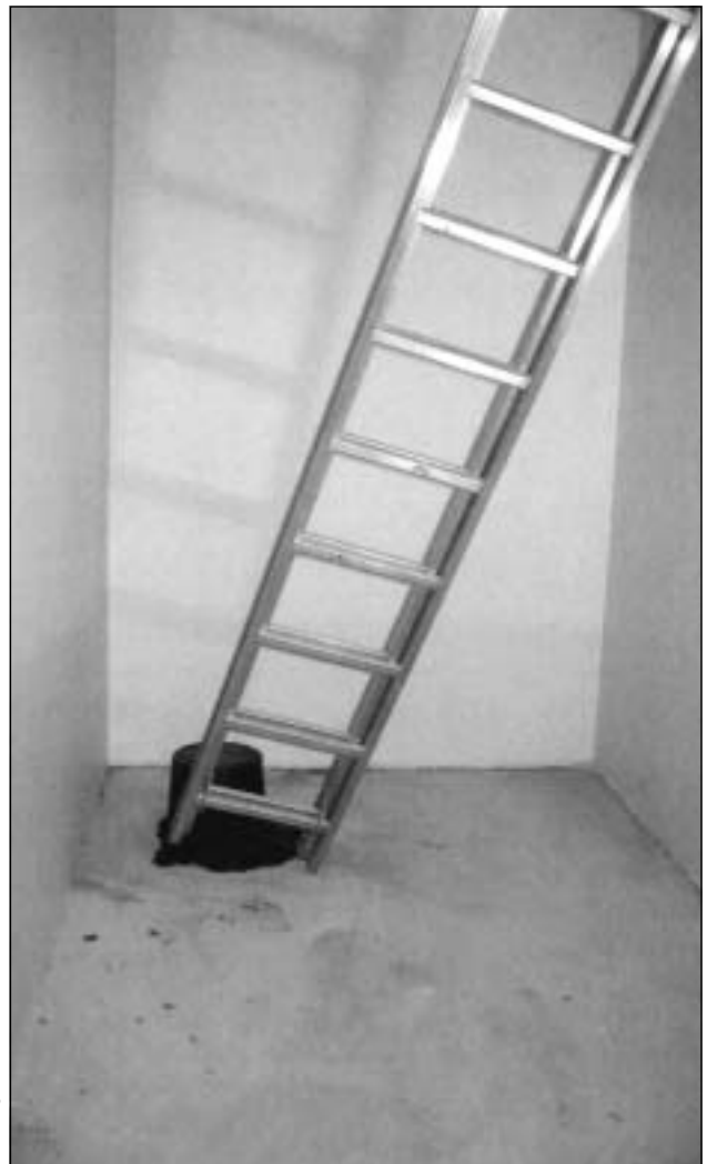
Kuva 2. Tikkaat vinossa putoamisen jälkeen, laastiämpäri.
