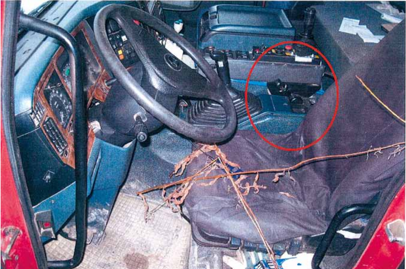
Kuva 3. Poliisin ottama kuva kuorma-auton ohjaamosta tapaturman jälkeen. Vaihde on vapaalla ja käsijarru ei ole kytkeytynyt päälle. Kuvassa käsijarru on korostettu punaisella ympyrällä.
