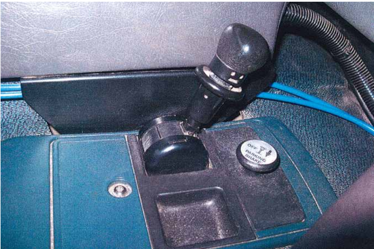
Kuva 4. Poliisin testitilanteessa ottama valokuva käsijarrusta. Kuvassa käsijarrun vipu on lukittuneena taakse ja vipu vapautuu nostamalla varressa olevaa salpaa (vapautusrengasta). Vapautettu vipu palautuu etuasentoon jousivoimalla.
