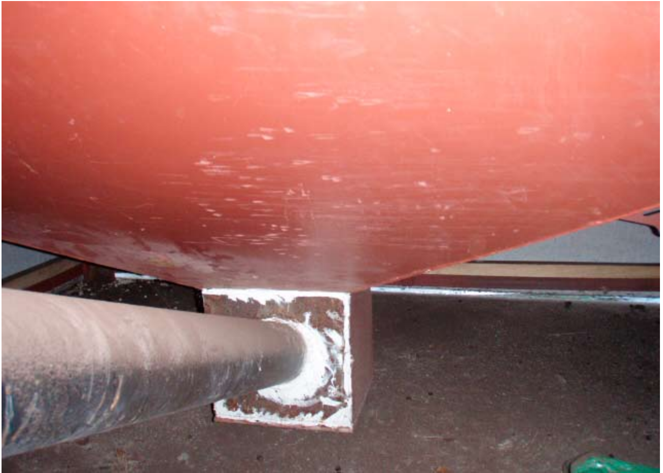
Kuva 2. Siilon pohja, jonka kallistuskulma on käyttöolosuhteisiin nähden liian pieni.
