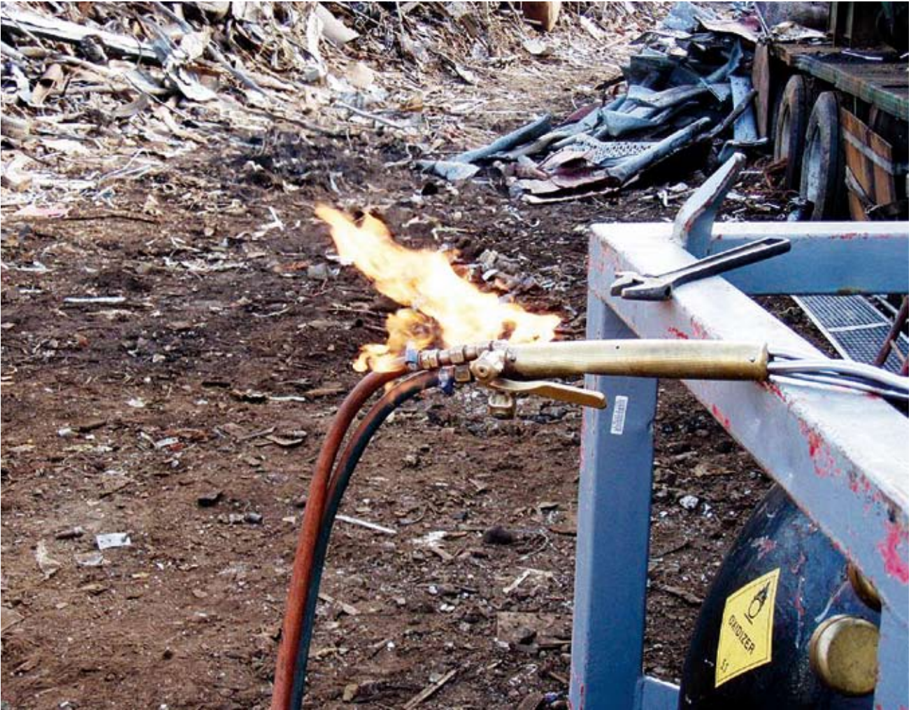
Kuva 2. Kuvassa näkyy takatulisuoja venttiilit (flash guard) ja se, että liittospintojen päät ovat erimittaiset. Liittimen vuoto aiheutti kuvassa näkyvän suuruisen jatkuvan liekin kun vuotava kaasu sytytettiin palamaan.
