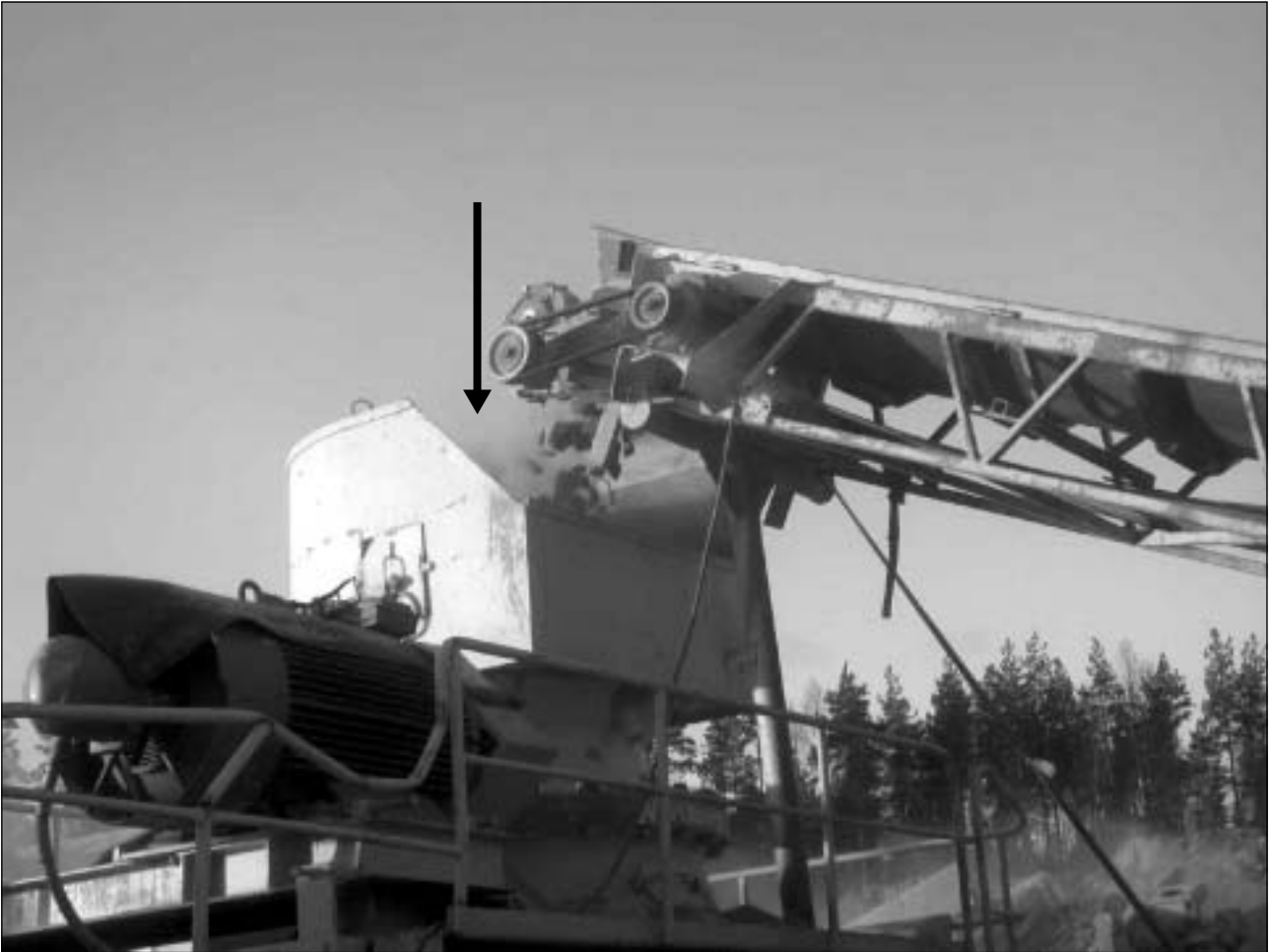
Kuva 1. Kivimurskainyksikön kuljetin. Nuoli osoittaa kohtaa, johon NN veti itsensä kuljettimen raudoista.
