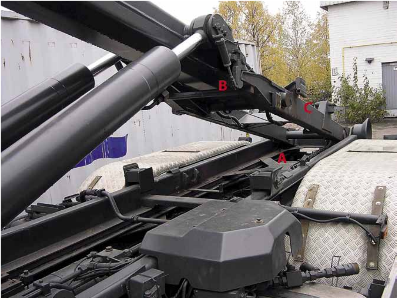
Kuva 1. Lavastettu kuva tilanteesta ennen tapaturmaa. NN istui auton rungon päällä kipin alla (NN:n paikka merkitty kuvaan A:lla, kipin runko on kuvassa C) ja löi lekalla auton perässä olevaa vetokitaa irti. Kipin hakamalliset lukot (kuvassa B) ovat paineilmatoimisia, lukon sylinterin sisällä näkymättömissä on toinen (avaava) jousi.
