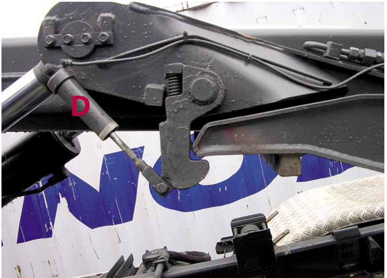
Kuva 2. Kipin lukko ”kiinni”-asennossa. Kuvassa näkyy välys, jonka vuoksi kippirunkoa pitää ylhäällä vain auton toisella puolella oleva lukko. Lukkojen auetessa sylinterin (D) sisällä oleva avaava jousi vetää lukon auki (kuvassa vasemmalle).
