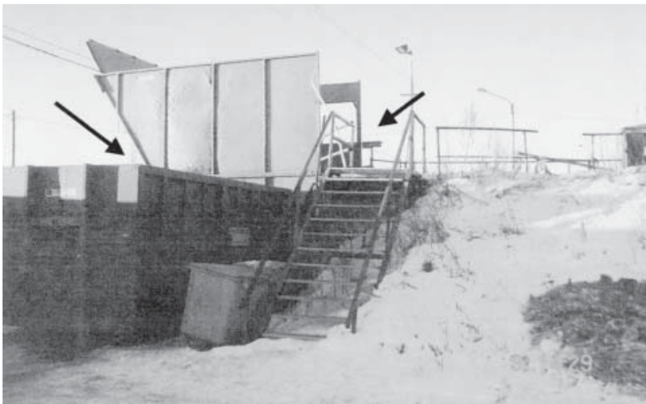
Kuva 1. Siirtokuormauspuristin, jolla tapaturma sattui. Jäteautot tyhjentävät säiliönsä ylätasanteelta jätekuiluun, josta mäntä painaa jätteet vasemmalla näkyvään konttiin. Puristinta voidaan käyttää sekä ylhäältä että alhaalta (nuolet). Tapaturman jälkeen NN:n kuorma-auto oli käynnissä vasemmalla näkyvän kontin edessä.
