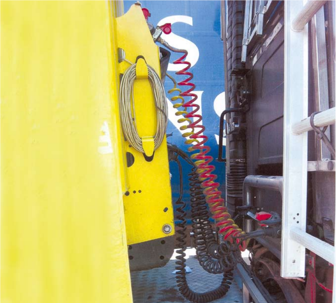
Kuva 1. Peruutettuaan vetoauton kiinni perävaunuun NN poistui ohjaamosta vetoauton ja perävaunun väliselle hoitotasolle ja kytki perävaunuun sähkö- ja ilmaletkut.
