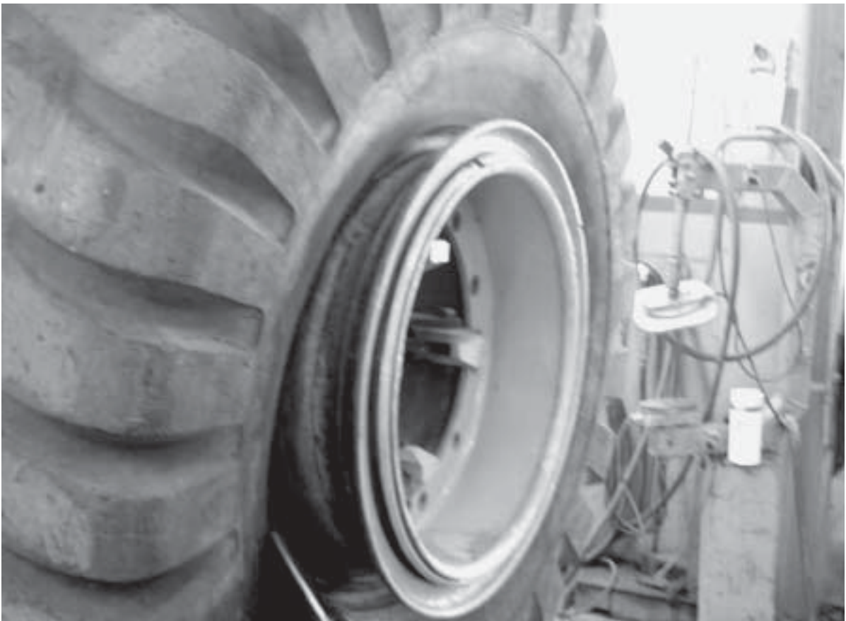
Kuva 2. Tässä renkaassa lukkorengas on asennettu paikoilleen niin kuin pitää.
