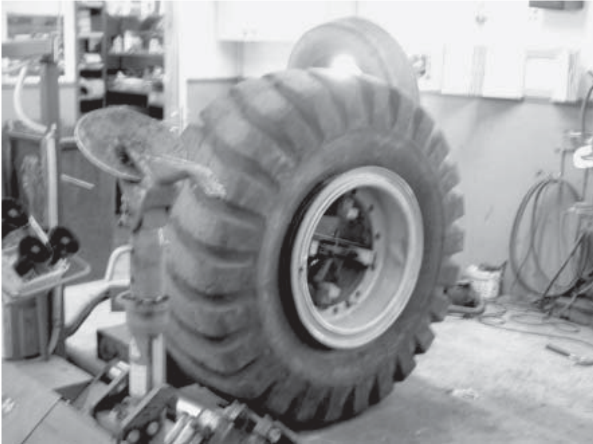
Kuva 3. Yleensä rengas täytyy laskea alas ja liikutella sitä laitteen avulla, jotta vanteen ja renkaan väli saataisiin niin tiiviiksi, että paineilma pysyy renkaassa. Tapaturmassa rengasta ei laskettu alas, ja NN seiso i renkaan edessä, kun se irtosi äkillisesti telineestä.
