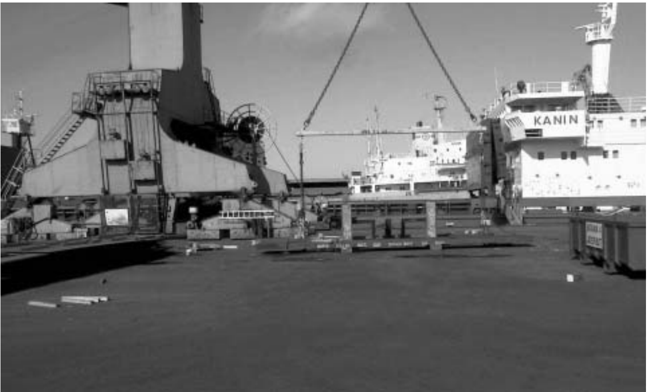
Kuva 2. Keskellä teräspukki, jonka päälle teräsaihiot laskettiin nosturilla, ja josta trukki nouti ne.
