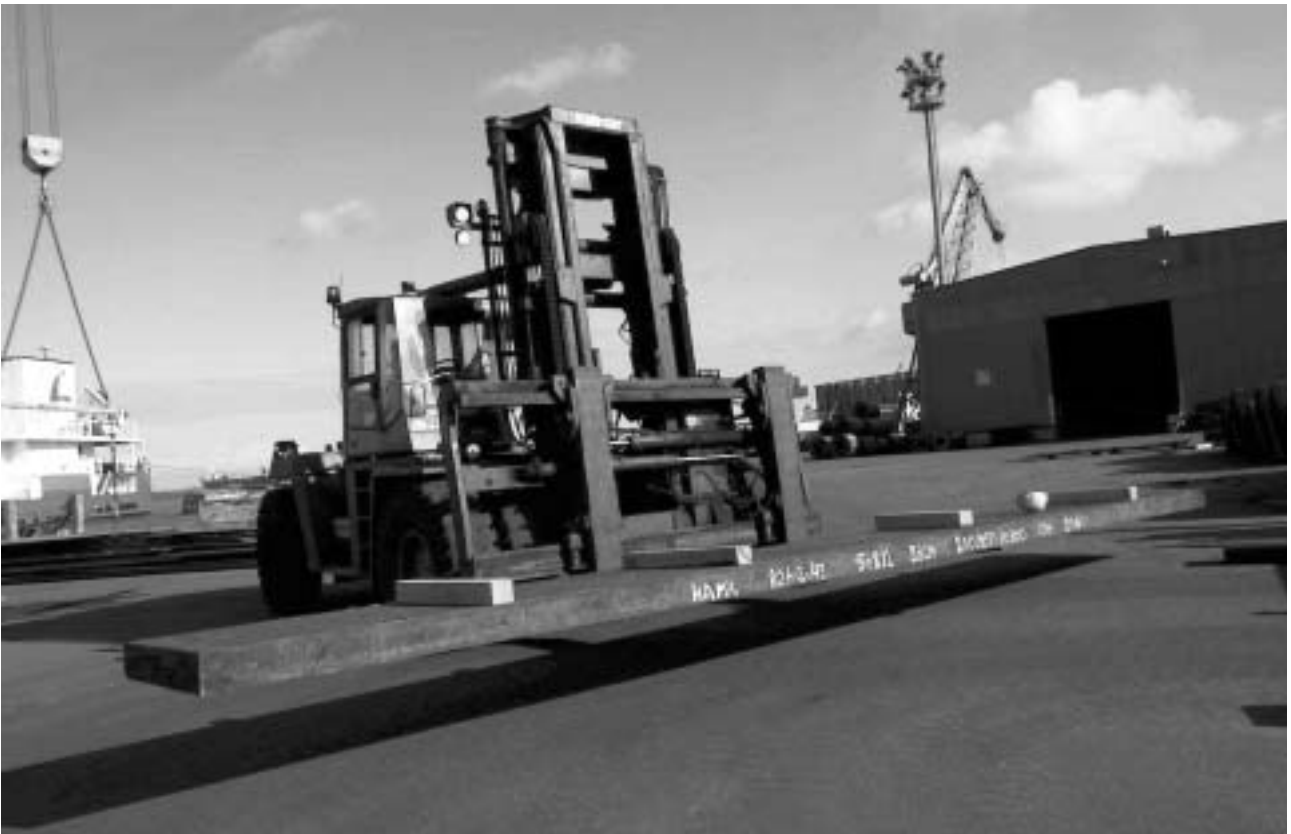
Kuva 3. Trukki ja sen piikkien päällä ollut teräsaihio. Teräsaihion päällä on NN:n ja hänen työtoverinsa asettamat välipuut.
