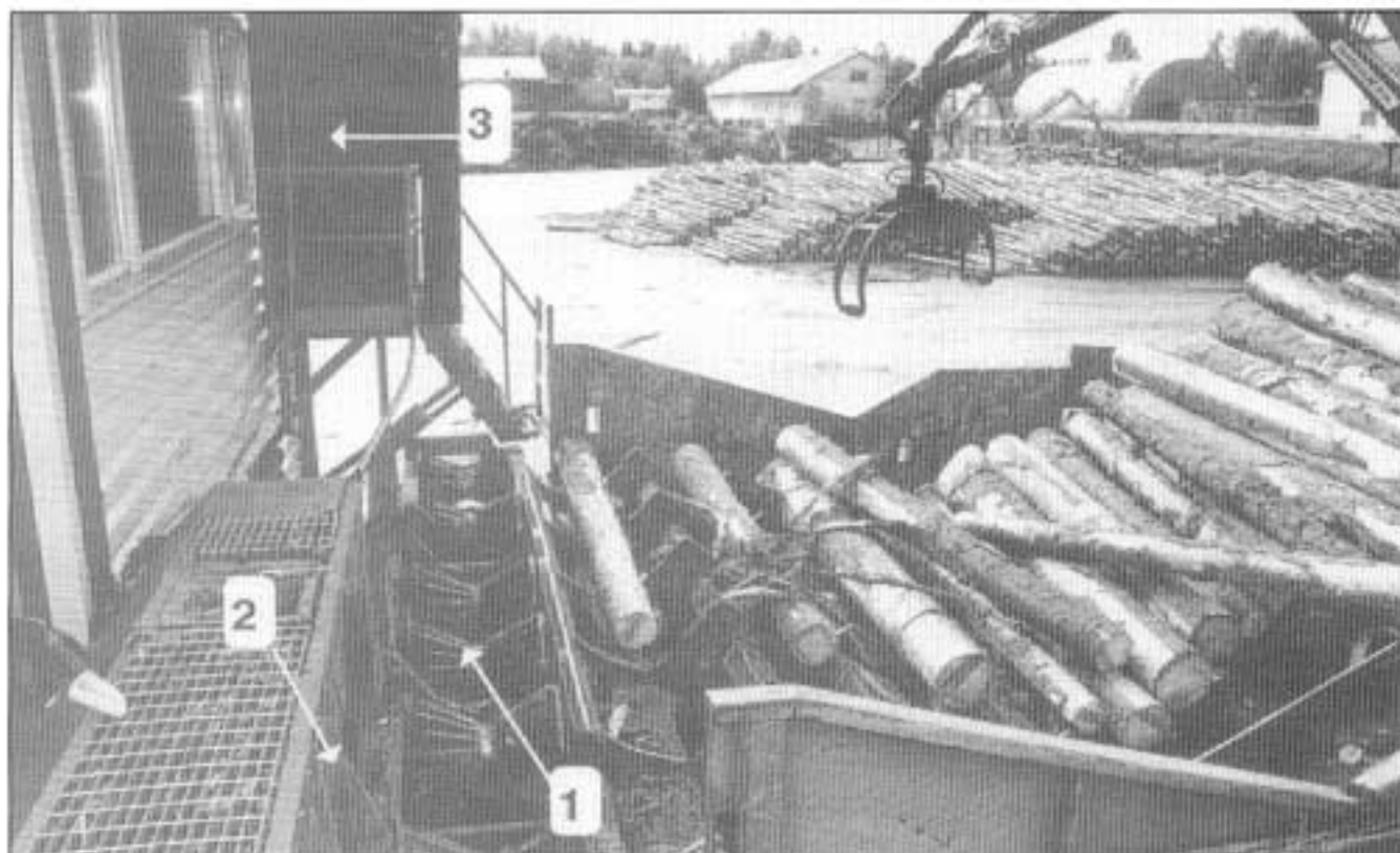
Kuva 1. 1) Nuoli osoittaa kartiorullakuljetinta, 2) nuoli osoittaa kartiorullakuljettimella olevaa valokennojen koteloa, 3) nuoli osoittaa valvomoon johtavaa ovea.
