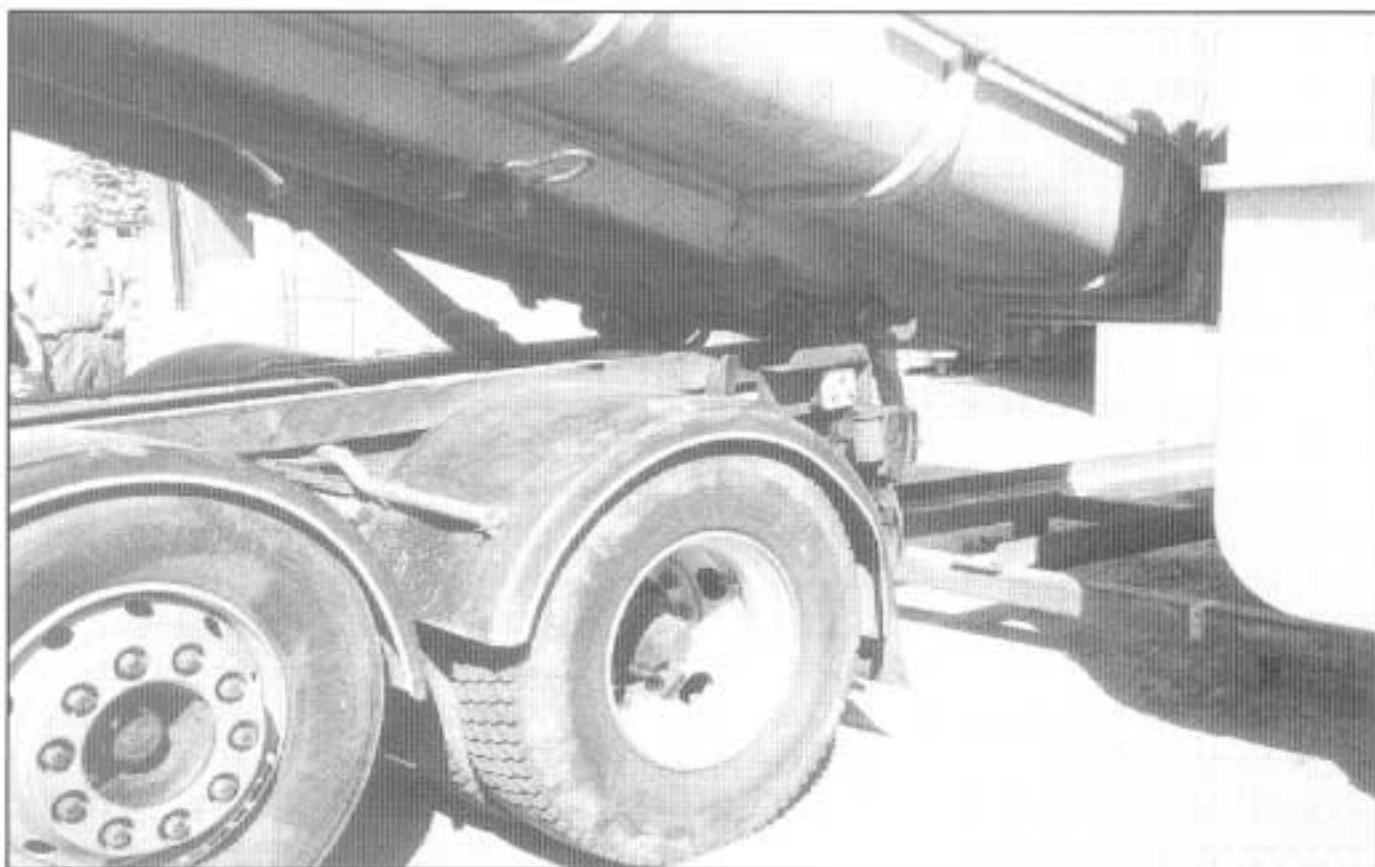
Kuva 1. Kontti lasketaan keskellä oikealla näkyville ohjainkiskoille.
