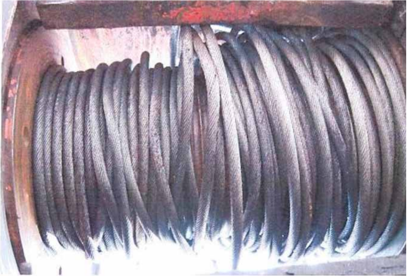
Kuva 2. Telalla löysällä ollut nostovaijeri tapaturman jälkeen.
