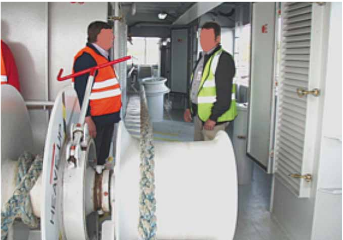
Kuva 3. Jälkikäteen lavastettu kuva, jossa oikeanpuolinen henkilö seisoo sillä kohdalla, missä NN seisoi tapaturmahetkellä ja käytti vinssiä pitkän jatkovarren avulla. NN:n normaali ajopaikka on kuvassa vasemmalla seisovan henkilön kohdalla.
