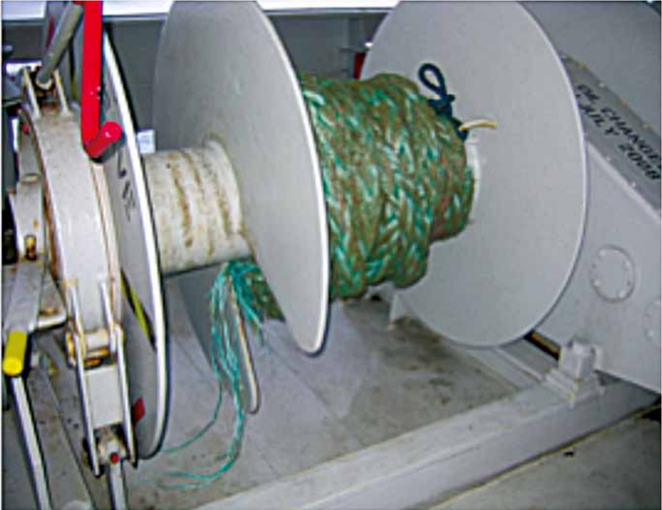
Kuva 1. Vinssin rummulle katkennut kiinnitysköysi. Kuvassa näkyy työ- ja varastorummut erottavan levyn aukon reunojen terävyys, joka aiheutti köyden katkeamisen.
