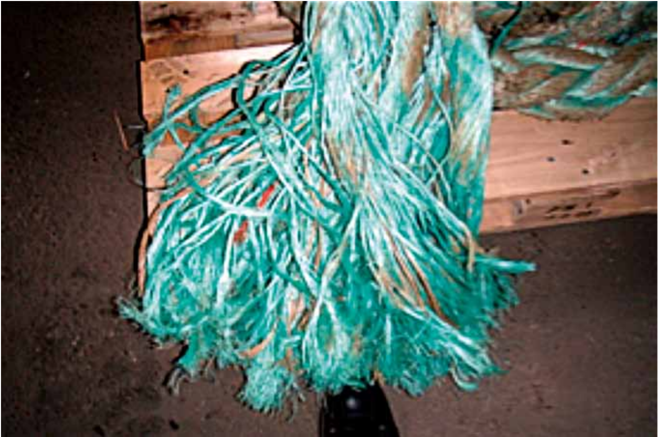
Kuva 2. Poikkileikkautuneen palmikoidun polypropyleeniköyden pää, josta on havaittavissa sen poikkileikkautuminen.
