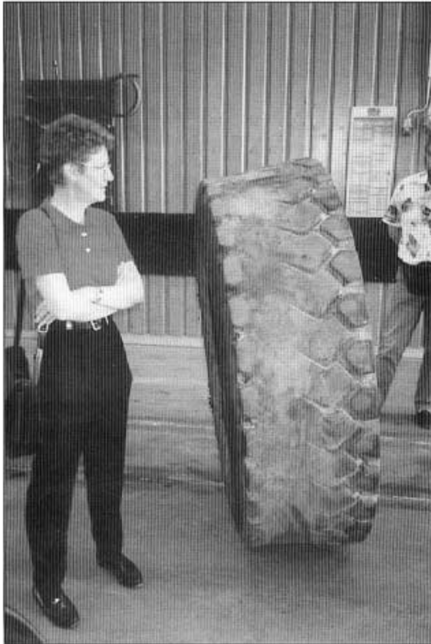
Kuva 2. Onnettomuuskurrottajan räjähtänyt ja voimakkaasti kulunut rengas.
