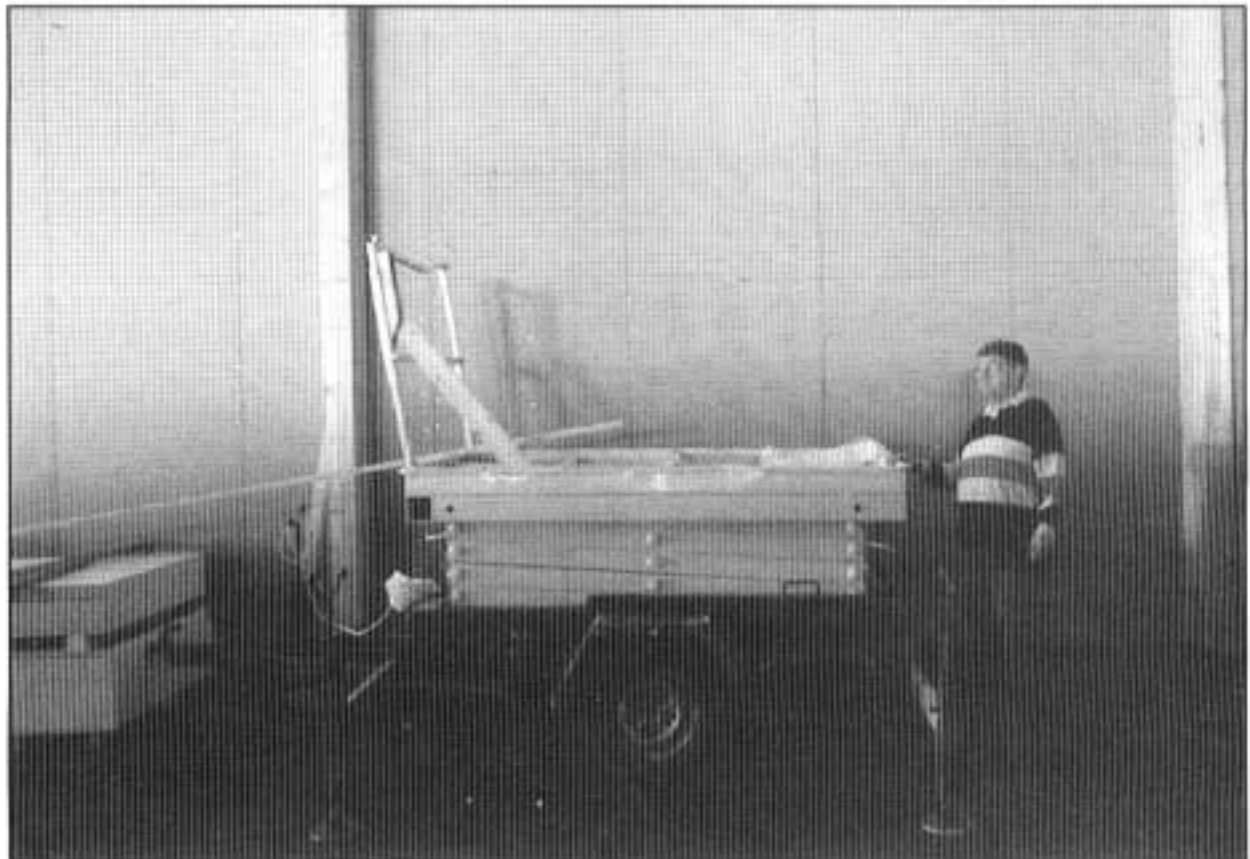
Kuva 4. Saksilava, jolla levyt nostettiin.
