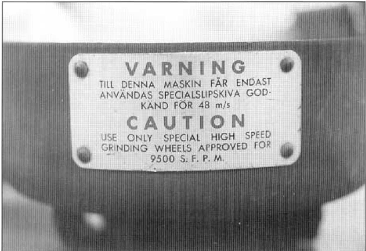
Kuva 6. Rikkomasuojuksen (oli siis poistettu) varoitukset.
