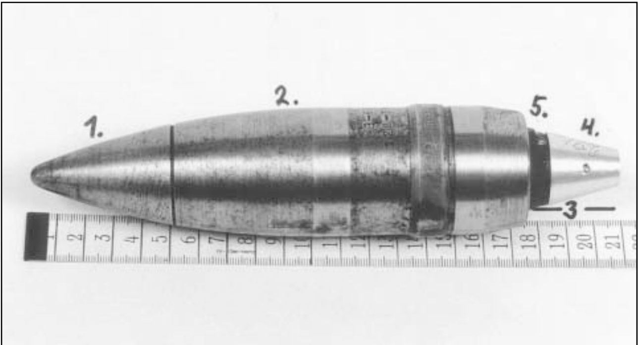
Kuva 5. Kuvassa rakenteeltaan vastaavanlainen pst-kraanaatti, joka räjähti hitsatessa. Kraanaatin kärkiosa poikittaiseen uraan asti on karkaistua metallia (1) ja siitä eteenpäin kraanaatti on valurautaa, jonka sisällä on 19,5 g trotyyliä (2). Takapäässä on kuparinen ohjainrenkas. Kuvassa näkyvässä kraanaatissa on vielä jäljellä sytytin (3). Räjähtäneestä kraanaatista oli poistettu alumiinilieriö, jossa on valujuovapanos (4). Räjähtäneessä kraanaatissa oli jäljellä sytyttimen pohjaosa (5), johon mutteri oli hitsattu kiinni.
