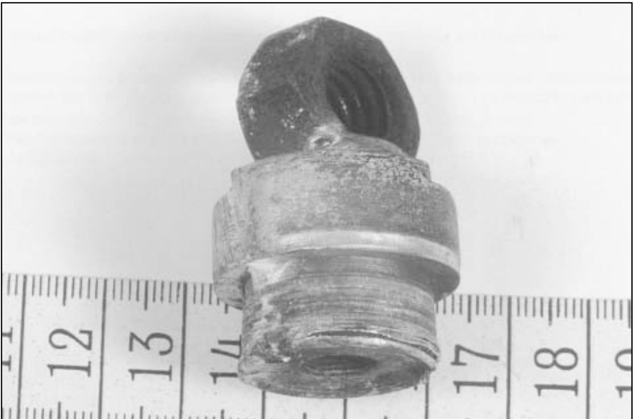
Kuva 4. Kuvassa räjähtäneen pst-kraanaatin sytyttimen pohja, joka löytyi verstaan takaosasta. Sytyttimen pohjaan oli hitsattu kuvassa näkyvä mutteri. Kuumenemisen vuoksi kraanaatti räjähti, jolloin sytyttimen pohjan kierteet pettivät räjähdyspaineesta. Sytyttimen pohjan muodon ja kierteiden ansiosta kraanaatin tyyppi pystyttiin varmistamaan.
