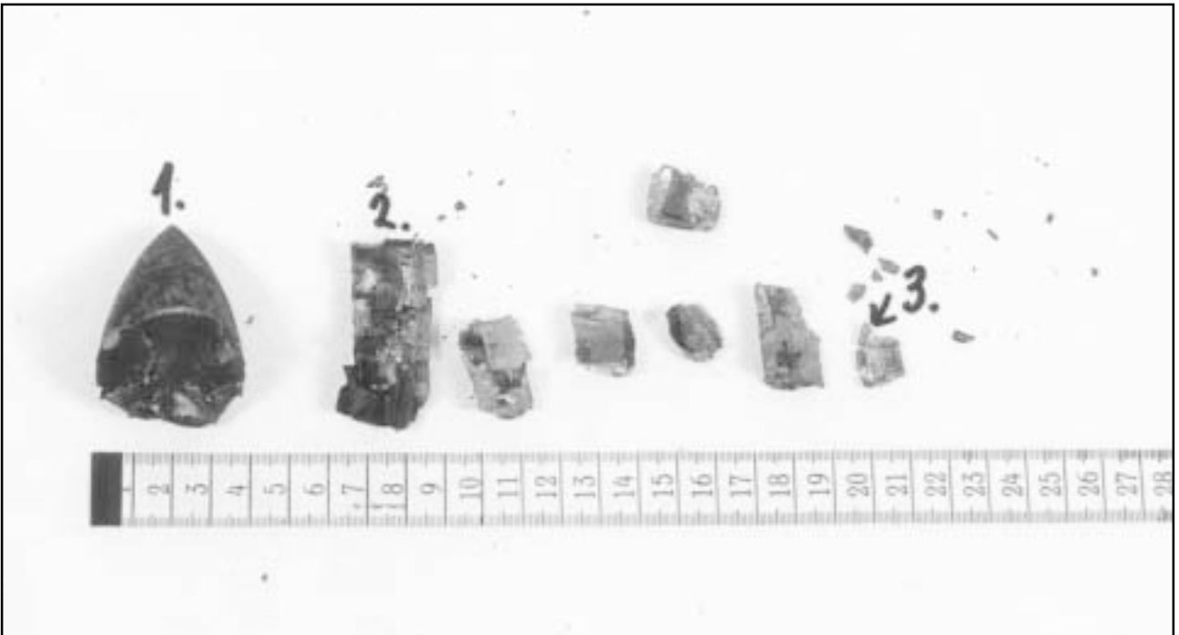
Kuva 3. Kuvassa tapahtumaverstaan sisältä löytyneitä osia räjähtäneestä pst-kranaatista. Vasemmalla (1) on kranaatin karkaistu kärkiosa, joka löytyi lattialta läheltä hitsauspaikkaa. Vasemmalta oikealle on kranaatin valurautaisia kappaleita, joita löytyi eripuolilta verstaasta. Suurimman palan (2) repeämispinnasta löytyi mm. haalarin kuituja ja verta. Oikealla kranaatin kuparisesta ohjainrenkaasta pala (3), joka löytyi metallisen silmälasikotelon sisältä.
