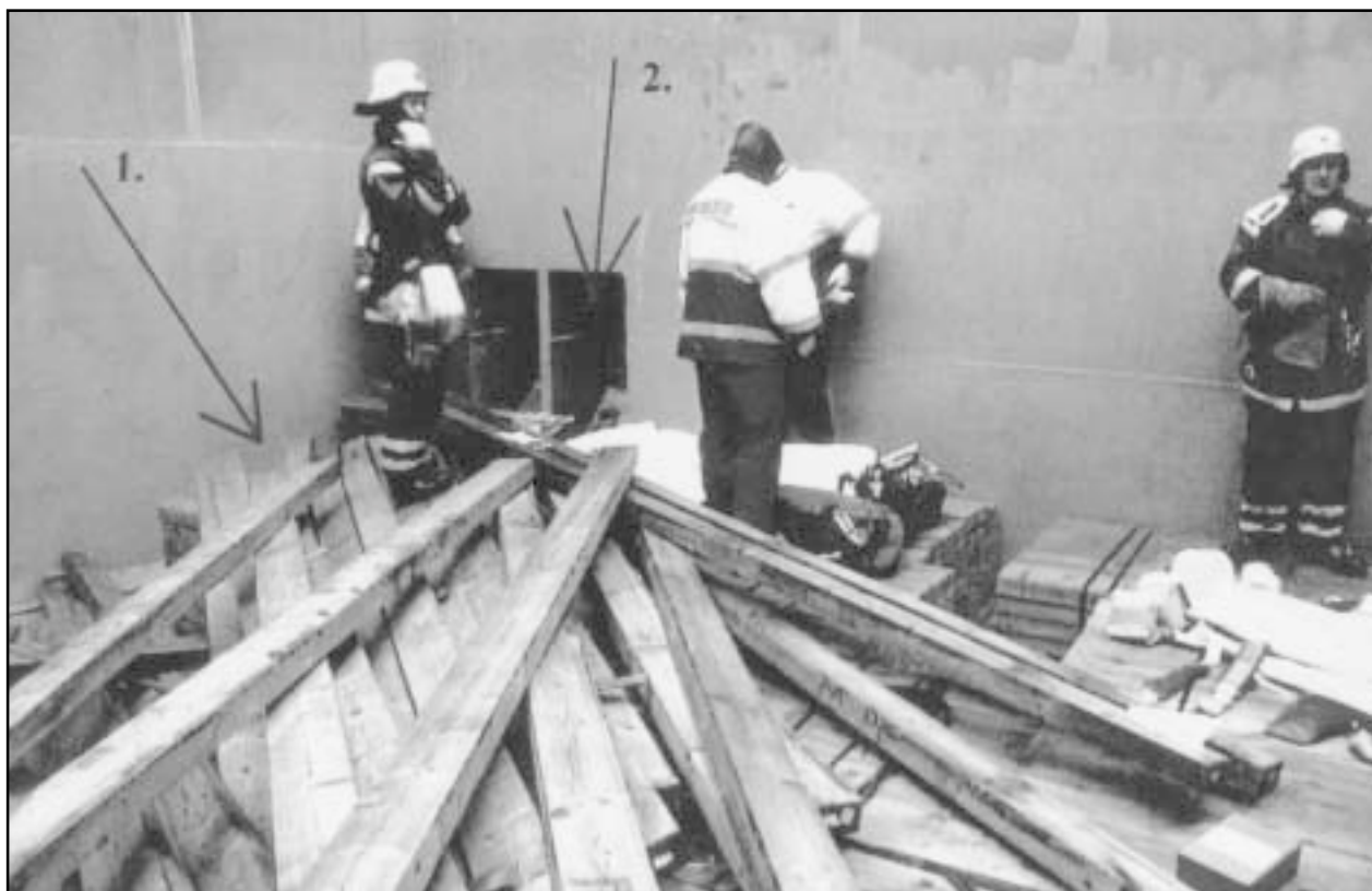
Kuva 4. Kuvassa ruumassa nurkkaus, jossa ahtaajat seisoivat taakkaa laskettaessa. Nuolella 1 osoitetussa kohdassa seisoj turmasta selvinnyt KK. Nuolella 2 osoitetussa paikassa näkyy oikeanpuoleinen ilmastointikuilu, jonne NN yritti paeta putoavia lankkuja.
