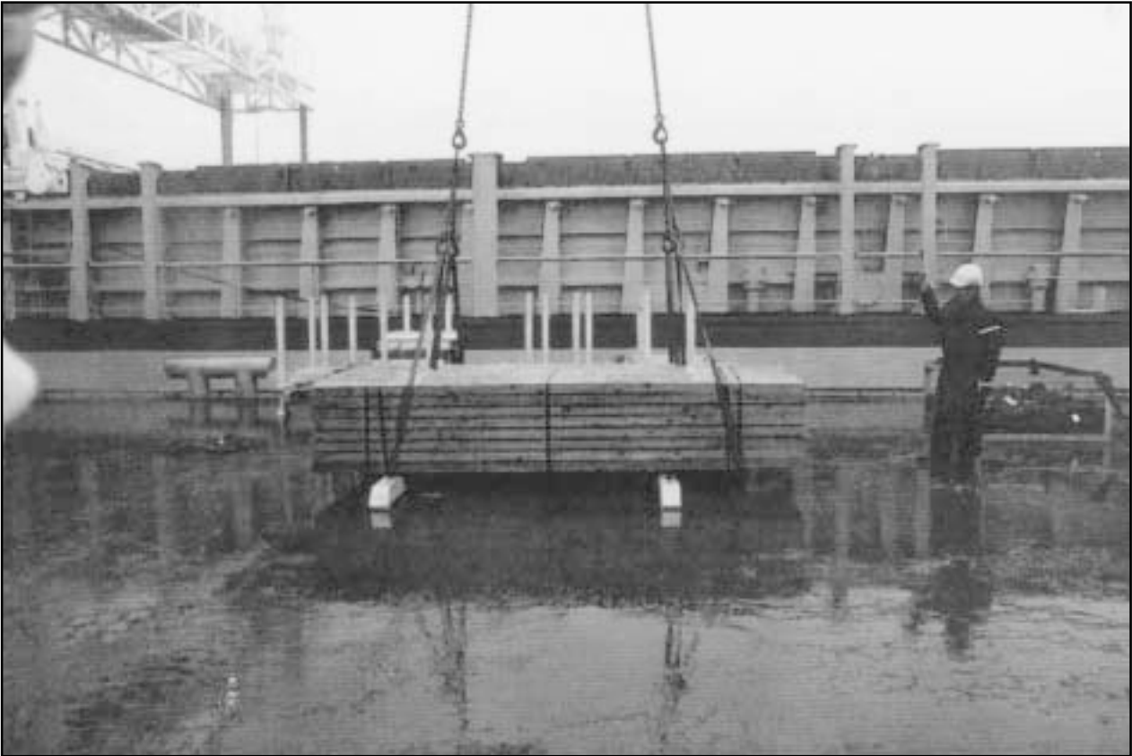
Kuva 1. Jälkeenpäin kuvattu nostotapa, joka oli käytössä. Nosturin koukusta lähtee kaksi noin 7–8 m:n ketjua, joissa molemmissa jakokettingit, joilla saadaan kiinnitettyä kaksi puutavarapakettia neljällä nostovyöllä.
