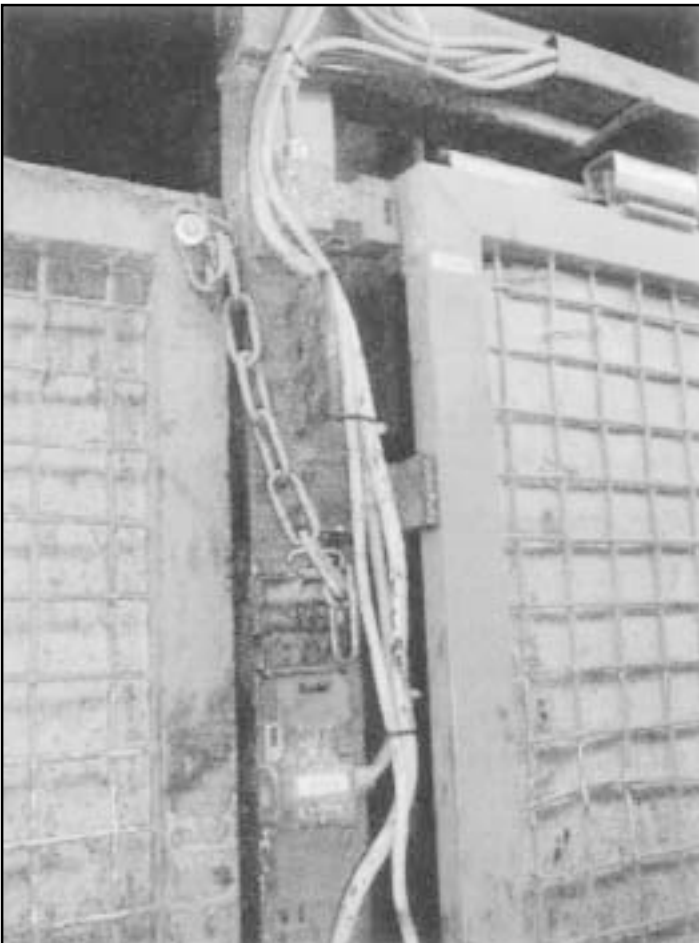
Kuva 2. Tapatur makohdan oven (A, pilarista vasemmalle) rajakytkimen kieli on kiinni pultatulla ketjulla ovesta.
