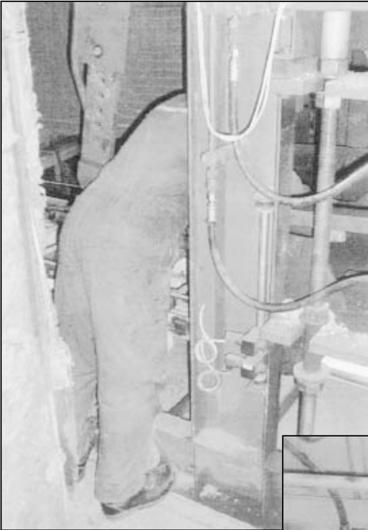
Kuva 5. Puristumiskohta avatun oven A suunnasta katsottuna. Jalkojen edessä on koneen runkopalkki, jolla NN on voinut seistä ja liukastua.
