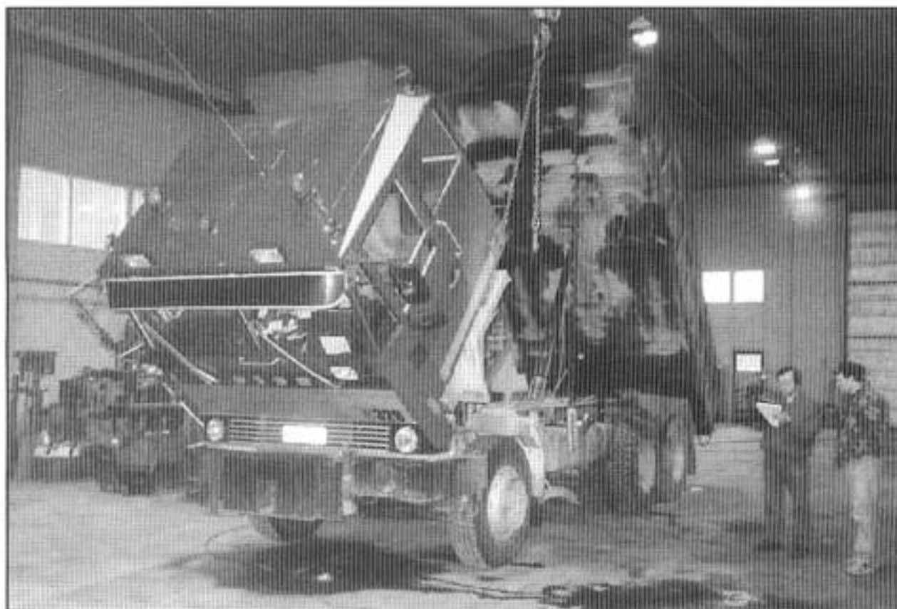
Kuva 2. Ohjaamon pysyminen ylhäällä varmistettu taljan ja nostoraksin avulla.
