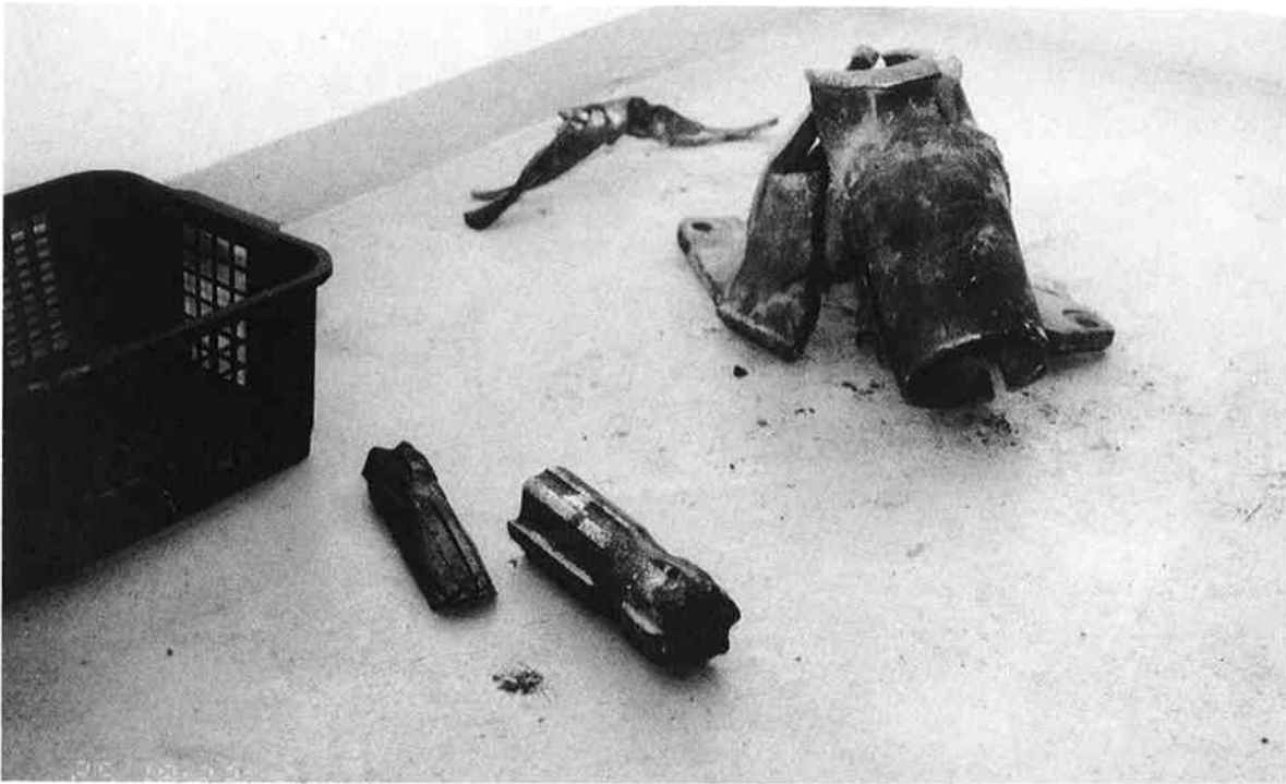
Kuva 3. Porakruunun kappale ja vieressä ehjä kruunu, putken sirpale ja pölysuojus.
