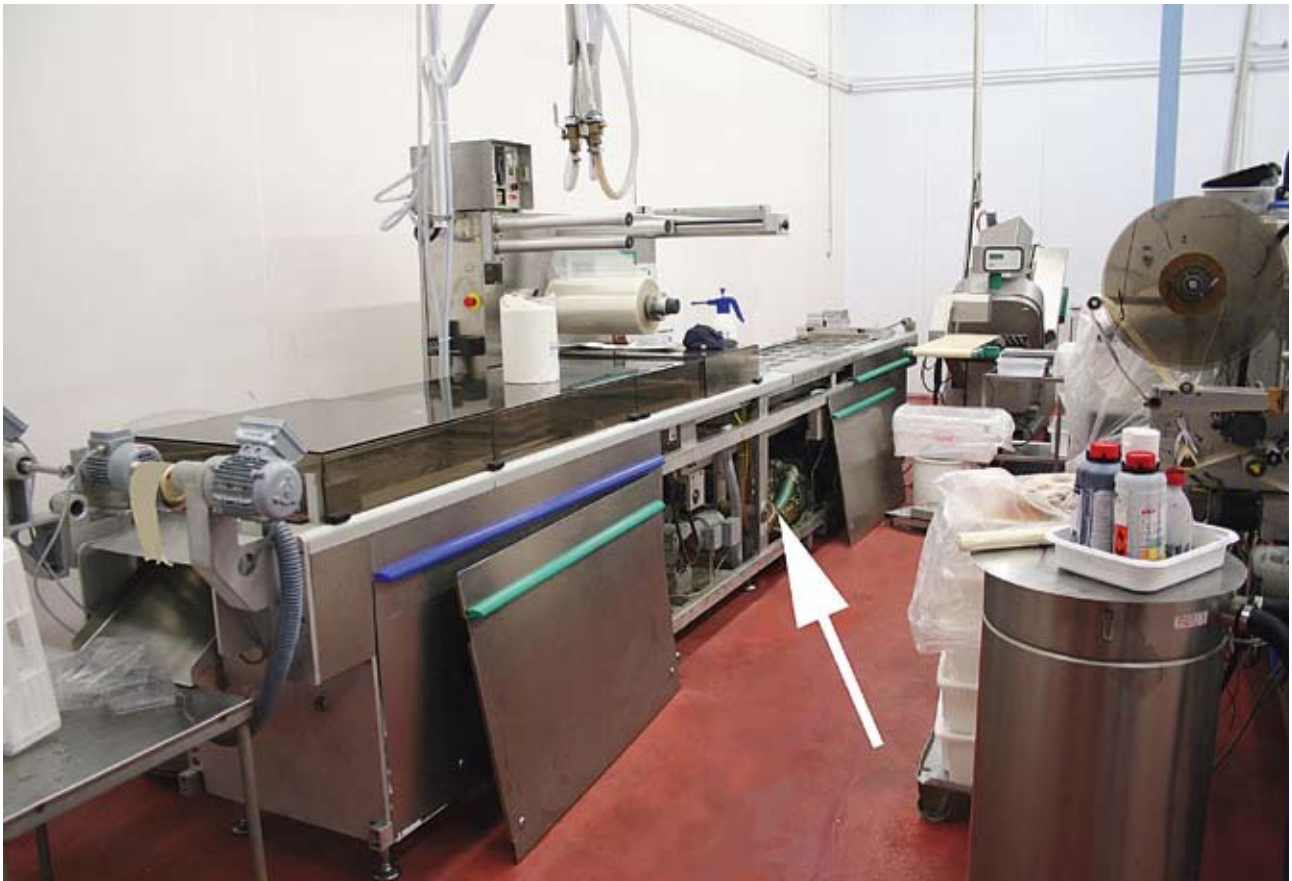
Kuva 2. Yleiskuva toisesta suunnasta; nuoli osoittaa puristumiskohtaa (kuvasta on poistettu tunnisteet).
