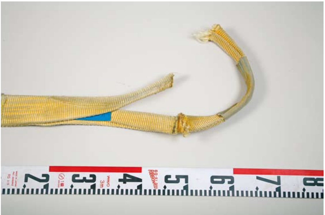
Kuva 4. Todennäköisesti teräväreunaisten palkkien nosto ilman kulmasuojia oli aiheuttanut liinoihin vaurioita, joista seurasi vetolujuuden merkittävä heikkeneminen.
