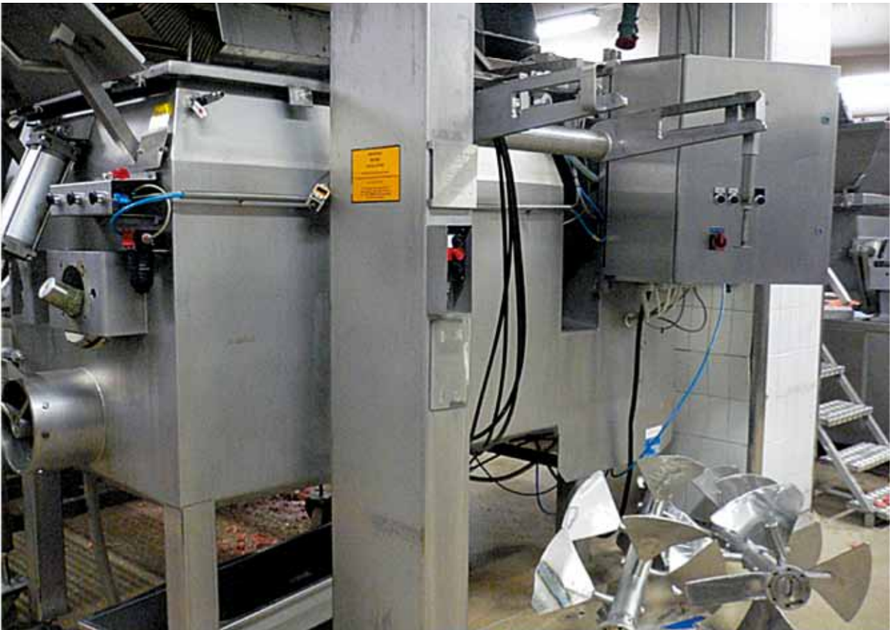
Kuva 2. Kuvassa oikealla on siilosta irrotetut sekoittimen akselit.
