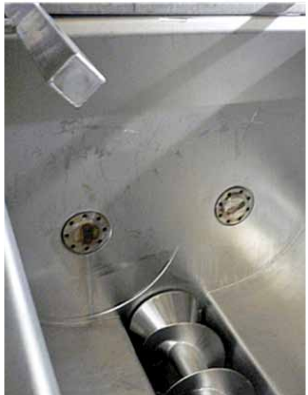
Kuva 3. Kuva siilosta, josta on irrotettu sekoittimen akselit. Pohjalla on tyhjennysruuvi.
