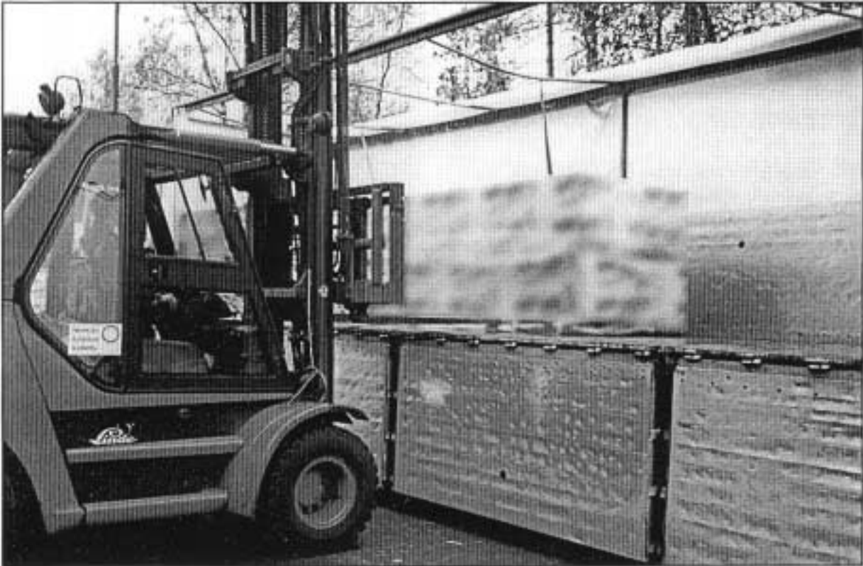
Kuva 1. Toisen rivin ensimmäinen nippupari työnnetään paikalleen. Kuljettajan puristumiskohta nippujen, laidan ja tolpan välissä. Vastaava tilanne kuin työtapaturmassa.
