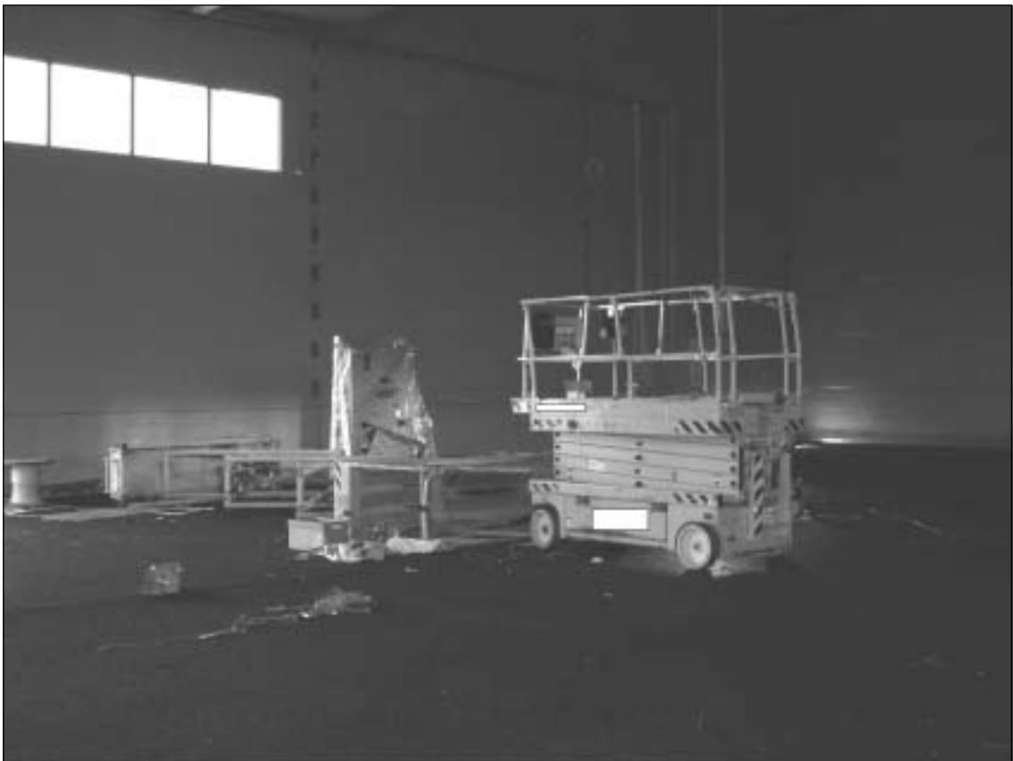
Kuva 2. Tapahtumapaikka toisesta suunnasta kuvattuna. NN putosi kaatuvan koneen nostokorista, ja iskeytyi koneen vieressä olleen toisen samankaltaisen koneen (kuvassa) nostokorin rakenteisiin.
