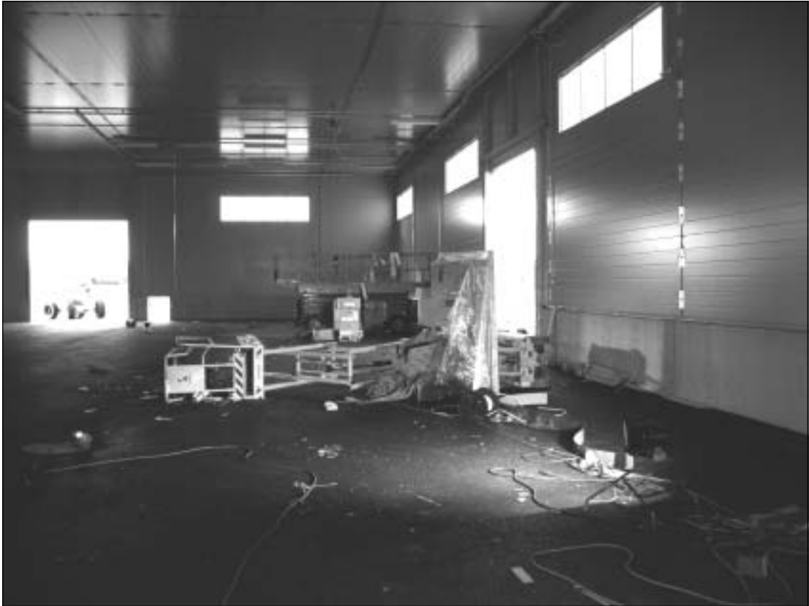
Kuva 1. Yleiskuva tapahtumapaikalta. Nostin kaatuneena hallin lattialla.
