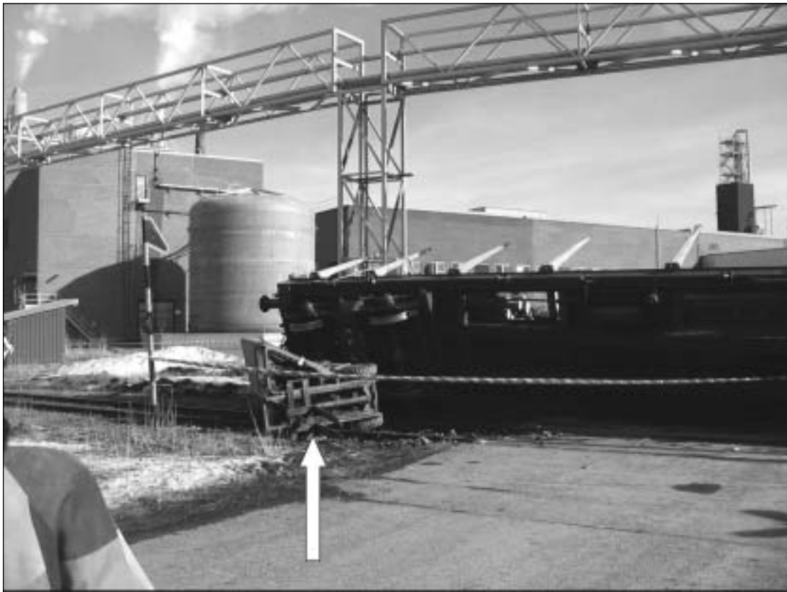
Kuva 1. Tapahtumapaikka trukin kulkusuunnasta kuvattuna. Nuolen osoittama trucki ajautui kulmittain viimeisen, eli kulkusuuntaan nähden ensimmäisen vauunun alle.
