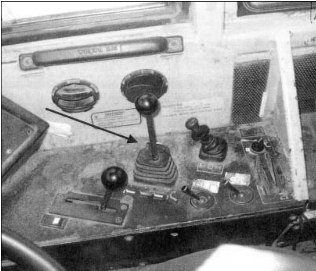
Kuva 5. Kipin käyttöhallintavipu voidaan lukita mekaanisella lukitussalvalla (ks. nuoli), jolloin vivun työntäminen lavan laskuasentoihin on estetty. Tätä lukintaa ei NN ollut kuitenkaan tehnyt.
