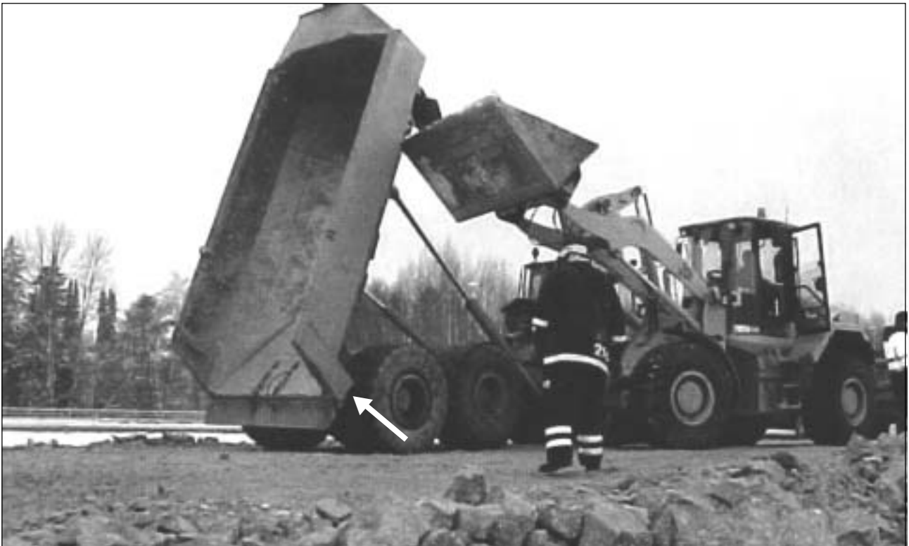
Kuva 6. Lukintaa varten on mentävä ylösnostetun lavan ja rungon väliin (nuoli).
