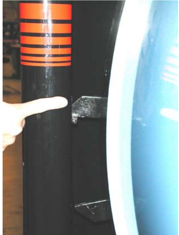
Kuva 3. Sormi osoittaa vastaavaa rajoitintappia, jollainen oli ennen tapaturmaa irronnut kammionasta.
