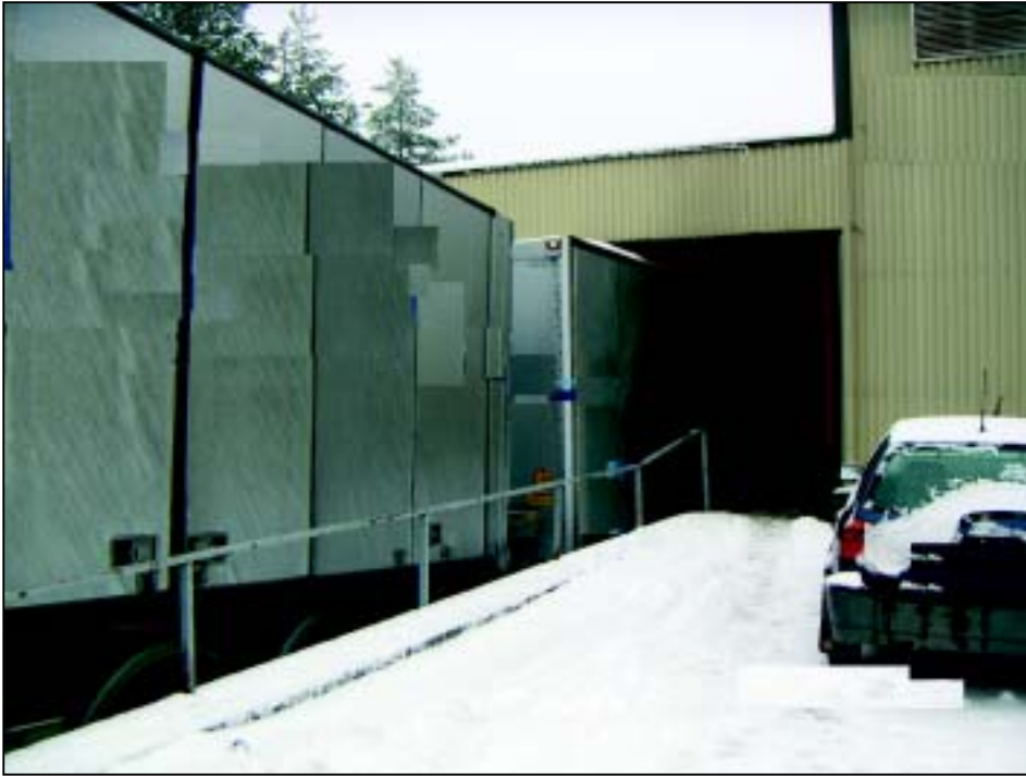
Kuva 1. NN:n kuljettaman yhdistelmän vetoauto jäi ajoluiskaan n. 10 % (= n. 5,7°) kallistukseen, perävaunun ollessa lastaustilassa tasaisella pinnalla.
