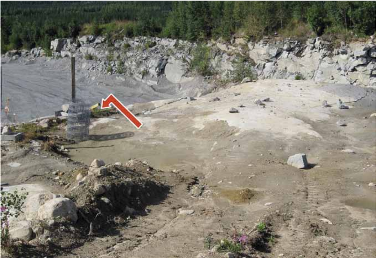
Kuva 2. Kallion laen epätasaisuudesta ja lievistä kaltevuudesta johtuen kompressori alkoi liikkua kohti rintausten reunaa. Rintausten reunan ja kompressorin välissä ollut NN yritti estää kompressoria putoamasta louhokseen.
