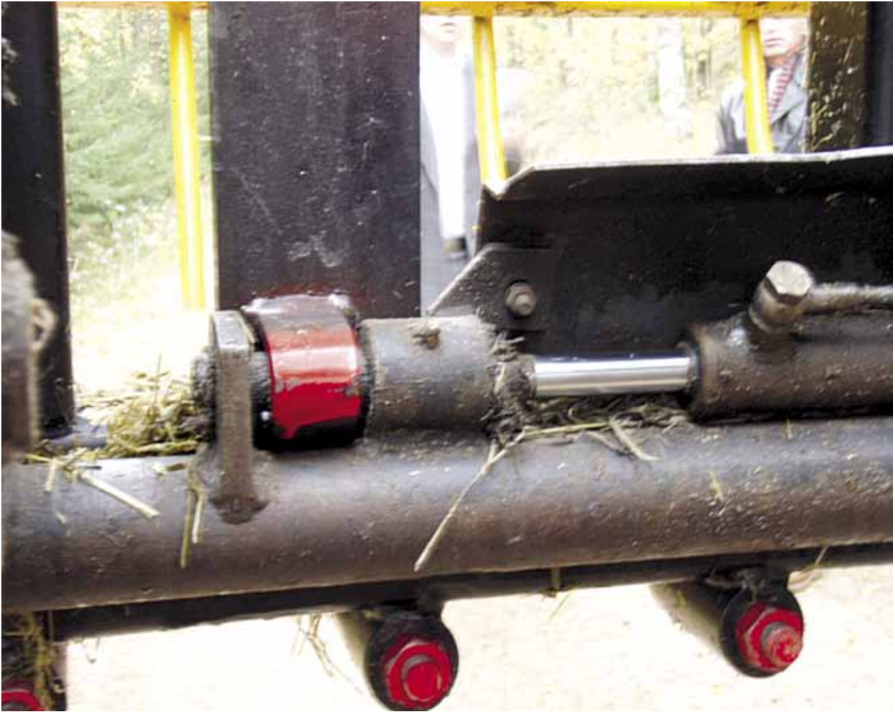
Kuva 1. Etukuormaajassa oleva rehukahmarin lukituslaite lukitusasennossa.
