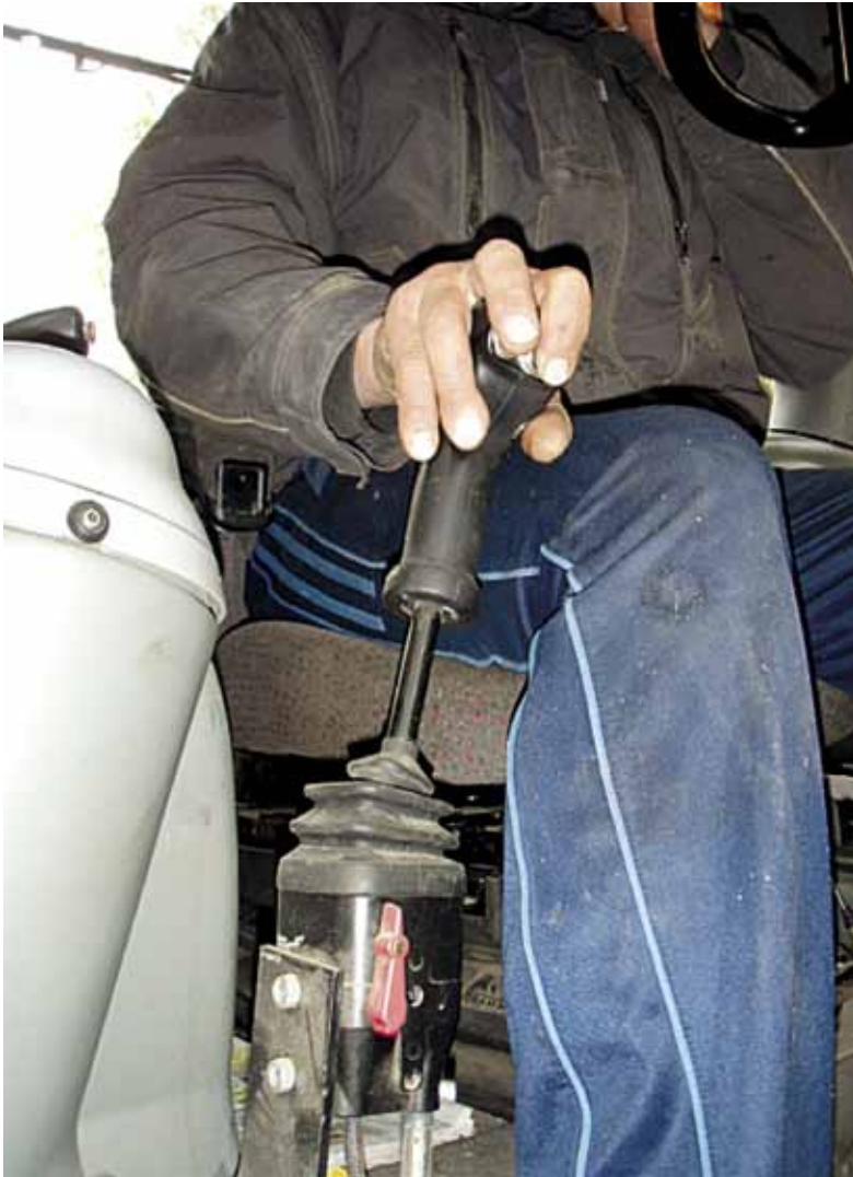
Kuva 3. Ohjaamossa oleva rehukahmarin lukitsemis- ja avaamisvipu. Jos rehukahmarin lukitus irrotetaan, pitää vipua kallistaa ja samalla painaa kahta painonappia etusormilla.
