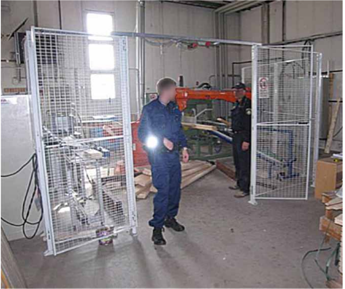
Kuva 2. Robottisoluun johtava avoinna oleva turvaportti.
