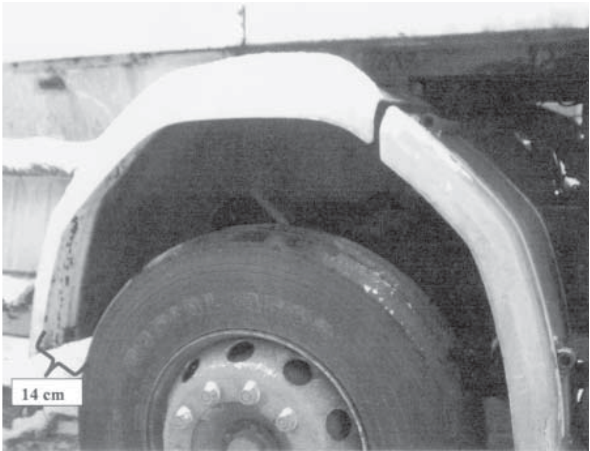
Kuva 3. NN kulkeutui pyörivän renkaan mukana renkaan ja lokasuojan välistä, joka on kapeimmillaan noin 14 cm.
