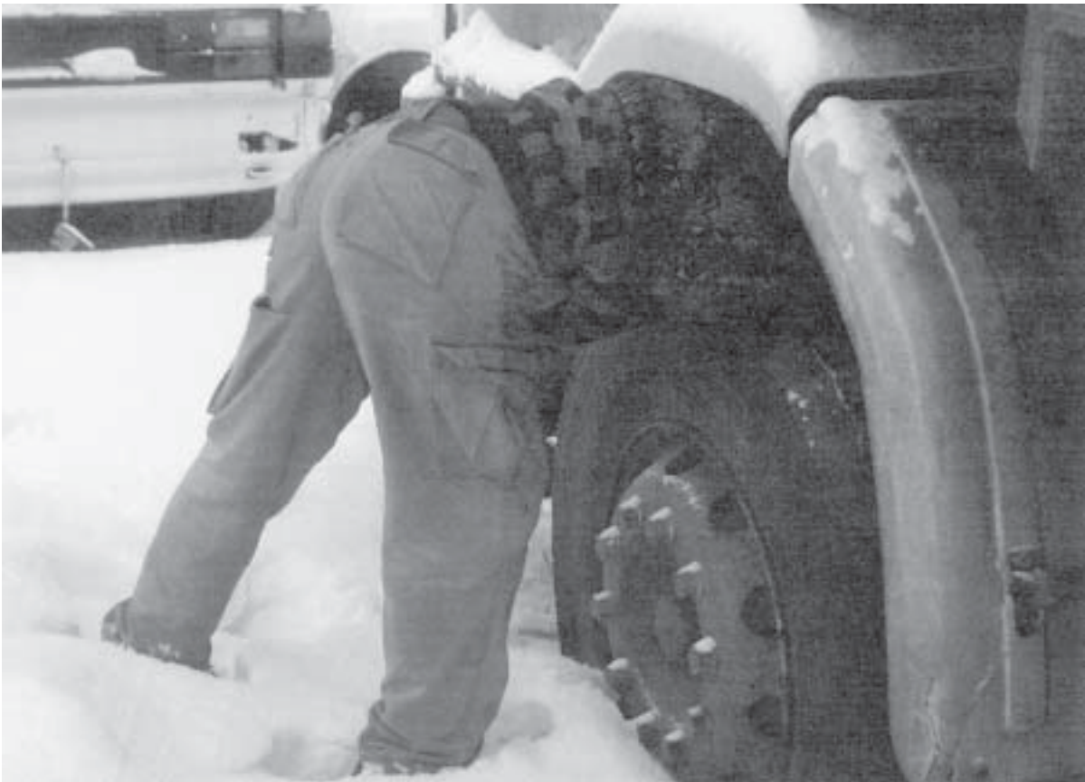
Kuva 2. Väli, josta NN ilmeisesti kurkotti poistaakseen jarrulle jääneen työkalun juuri ennen kuin dynamometrin rullat alkoivat pyörittämään rengasta.
