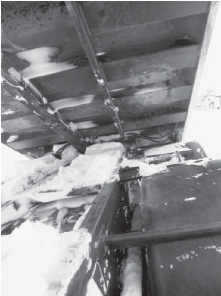
Kuva 4. Kuorma-auton runko- palkkien välissä rungon sivuilla oli runsaasti lunta tapaturma- hetkellä.
