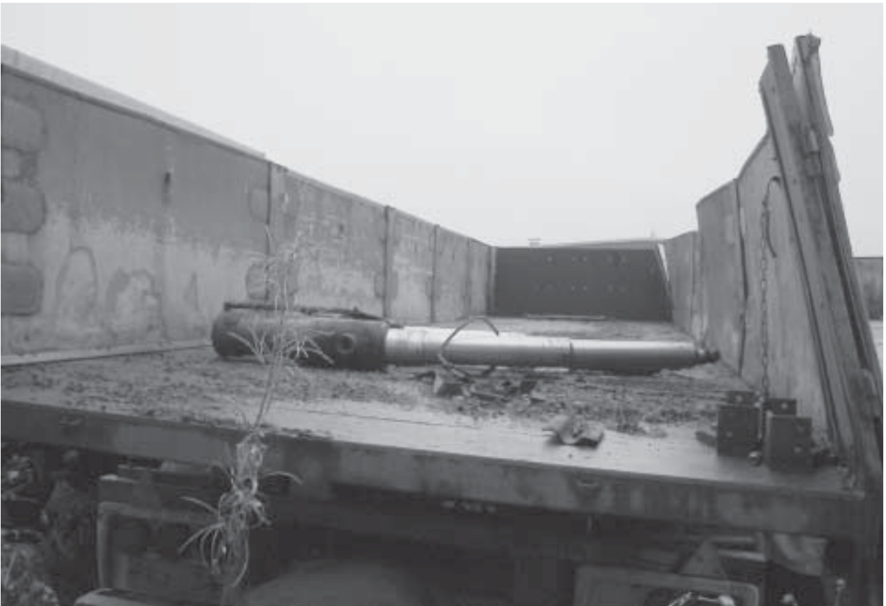
Kuva 3. Perävaunun lavalle nostetut vääntyneet nostosylinterit.
