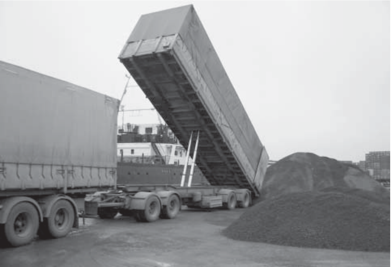
Kuva 1. Oliivikivimurskelastin tyhjentäminen alueella, jossa tapaturma sattui. Perävaunu on samanlainen kuin tapaturmassa mukana ollut perävaunu.
