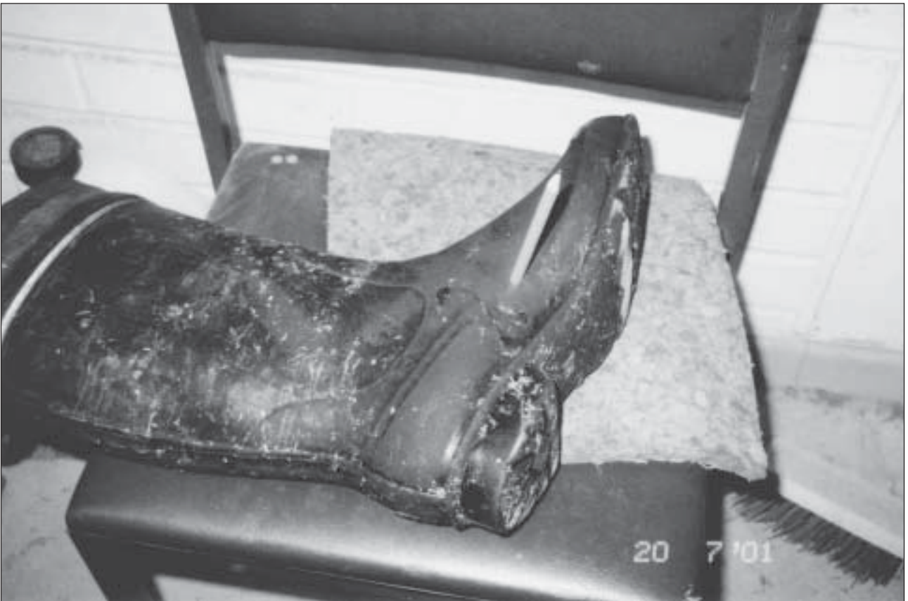
Kuva 2. NN:n kumisaapas. Salama kulki kynän osoittamasta reiästä.
