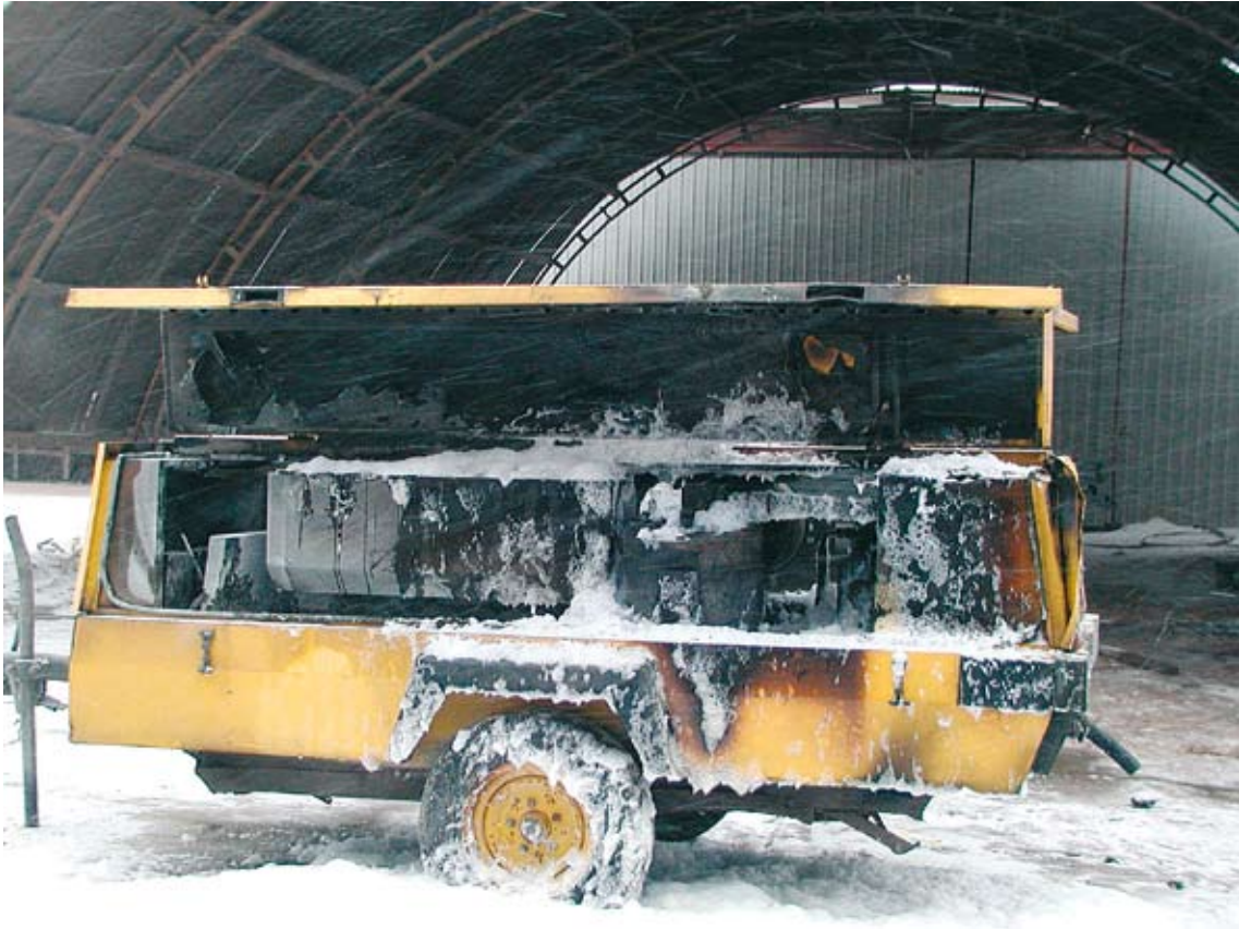
Kuva 1. Kompressori tulipalon sammuttamisen jälkeen.
