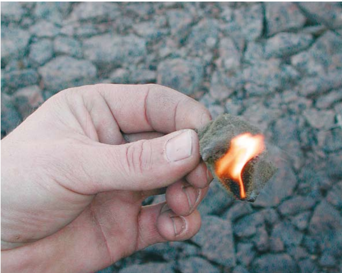
Kuva 4. Kompressorin konesuojan sisäpuolella ollut eriste syttyi helposti palamaan.
