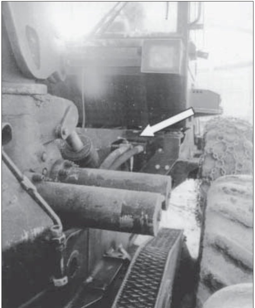
Kuva 3. Pulssianturi ja anturin kytkin. Kytkin kiinnitetään pidätinruuvilla anturin akseliin.
