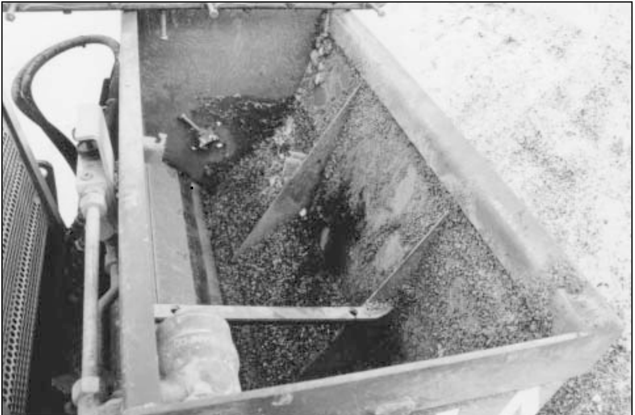
Kuva 2. Hiekoitussäiliö. Sekoitusakseli irrotettu pelastustoimien yhteydessä.
