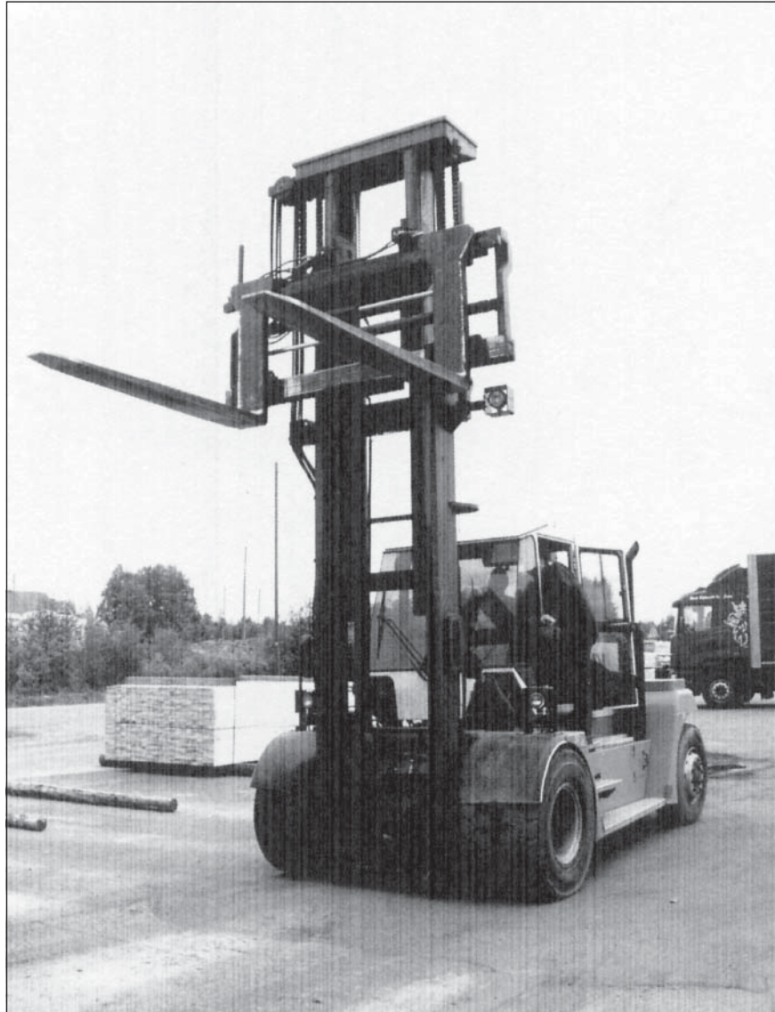
Kuva 3. NN seisoi trukin edessä haarukkavaunun sakaroiden alla voidellessaan trukin mastoa.
