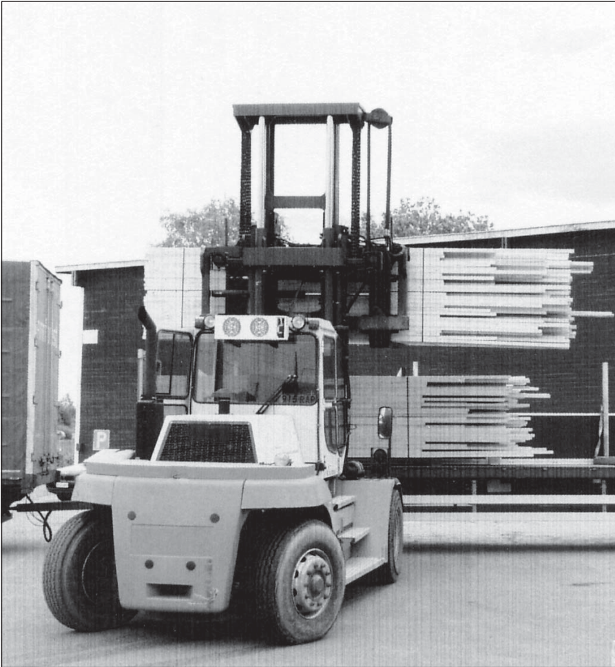
Kuva 1. Puutavaran tyypillinen lastaustilanne ajoneuvon. Normalissa trukki-työskentelyssä kuvan esittämä tilanne oli ylin käytetty nostokorkeus.
