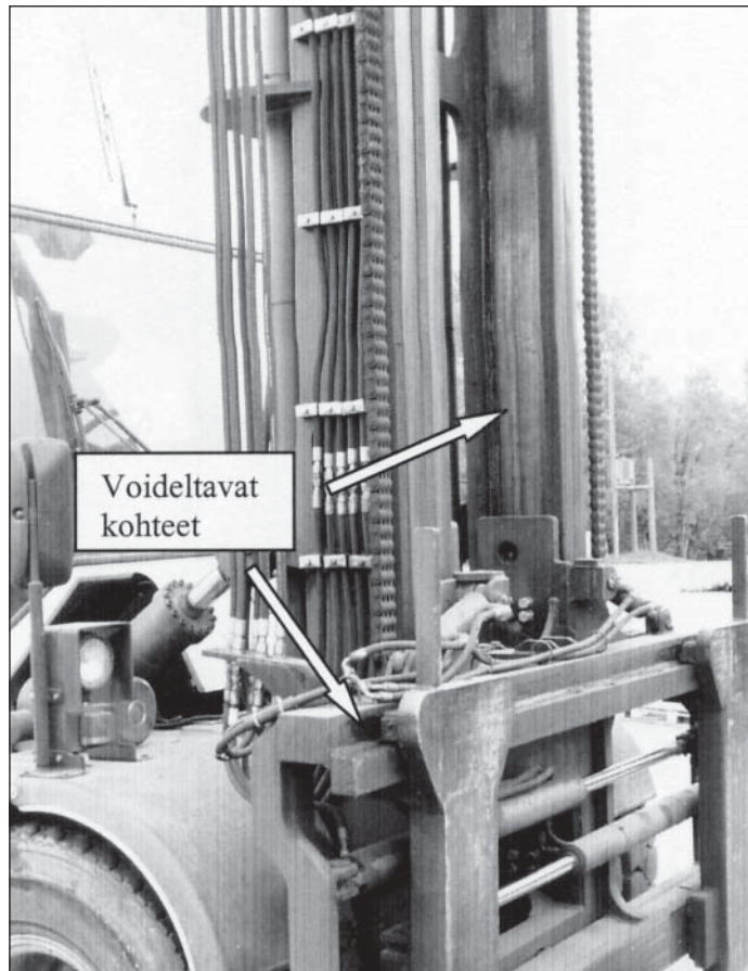
Kuva 2. Trukin haarukkavaunun voideltavat kohteet.
