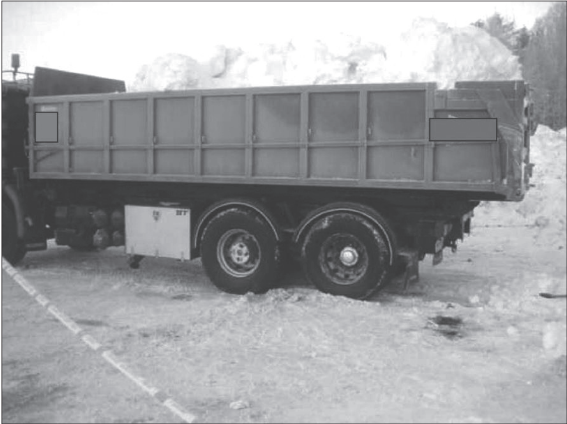
Kuva 1. Kuva autosta heti tapaturman jälkeen. Lumikuorma on siirtynyt hieman kohti peräluukkuja.
