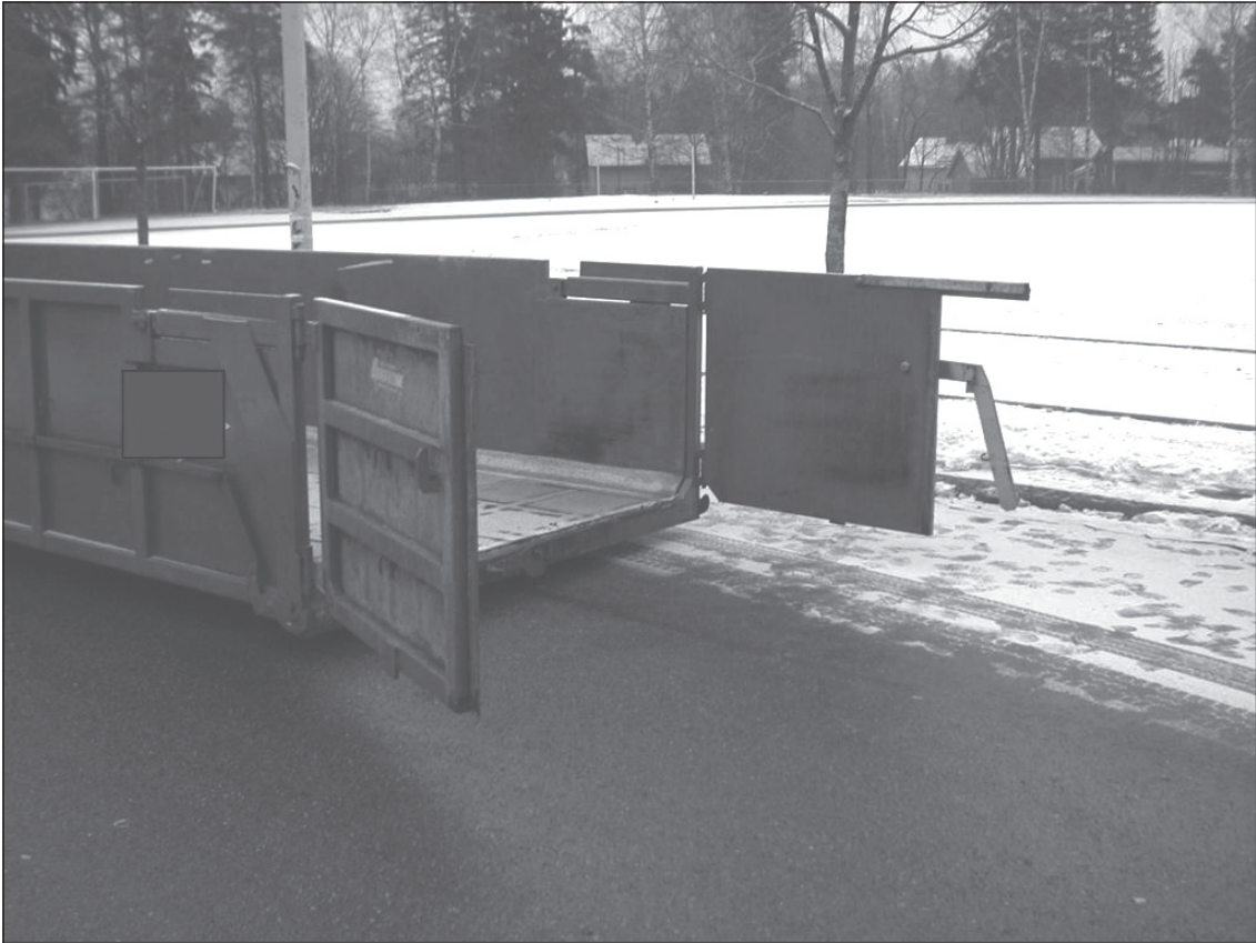
Kuva 3. Keskilukitus avattuna. Kuva on otettu tapahtumien jälkeen.
