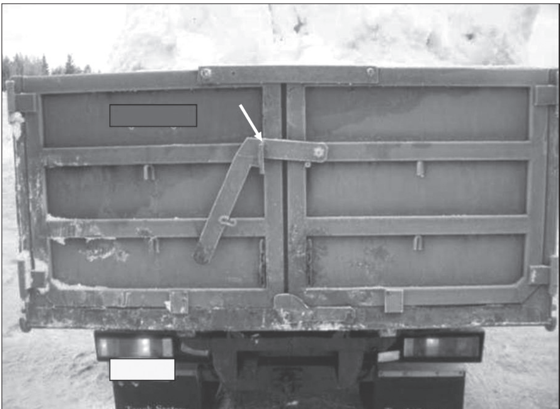
Kuva 2. Kuva perästä. NN ei kyennyt aukaisemaan keskuslukitusta (osoitettu nuolella), sillä kipatessa osin ulos työntynyt lumikuorma työnsi luukkuja ylös jumittaen samalla keskilukituksen.
