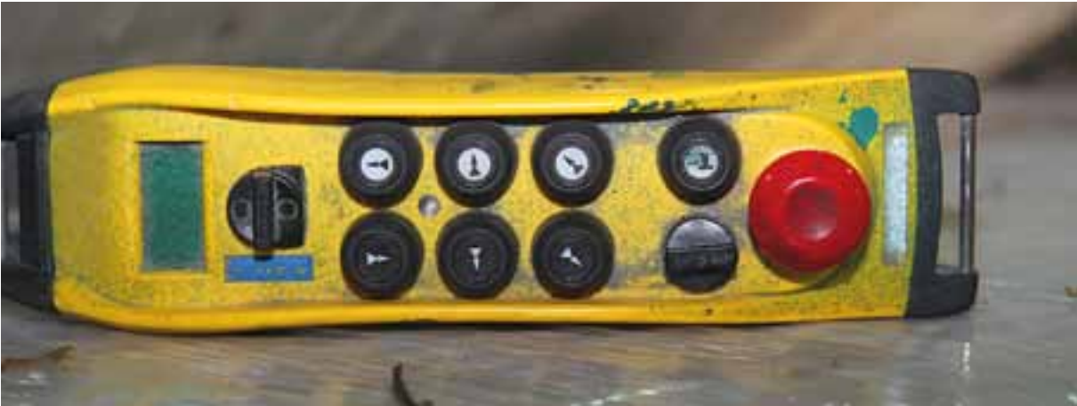
Kuva 2. NN ajoi nosturia liian pitkälle sivulle liinojen löysäyksen jälkeen. Nosturin ohjaus tapahtui kuvan kauko-ohjaimella. Teknistä vikaa nosturista tai sen ohjausjärjestelmästä ei löydetty.
