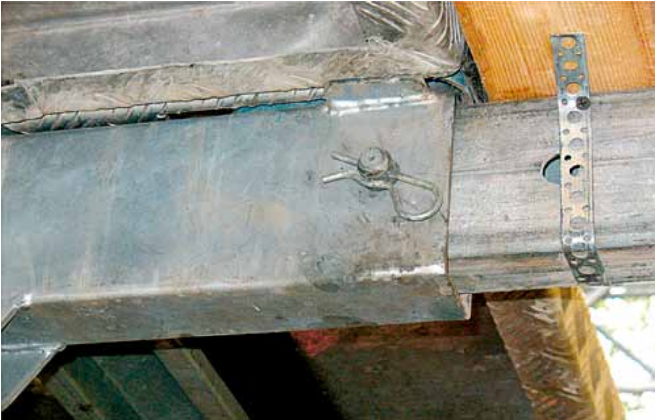
Kuva 10. Konsoli lukitaan sokalla työtason runkoon.
