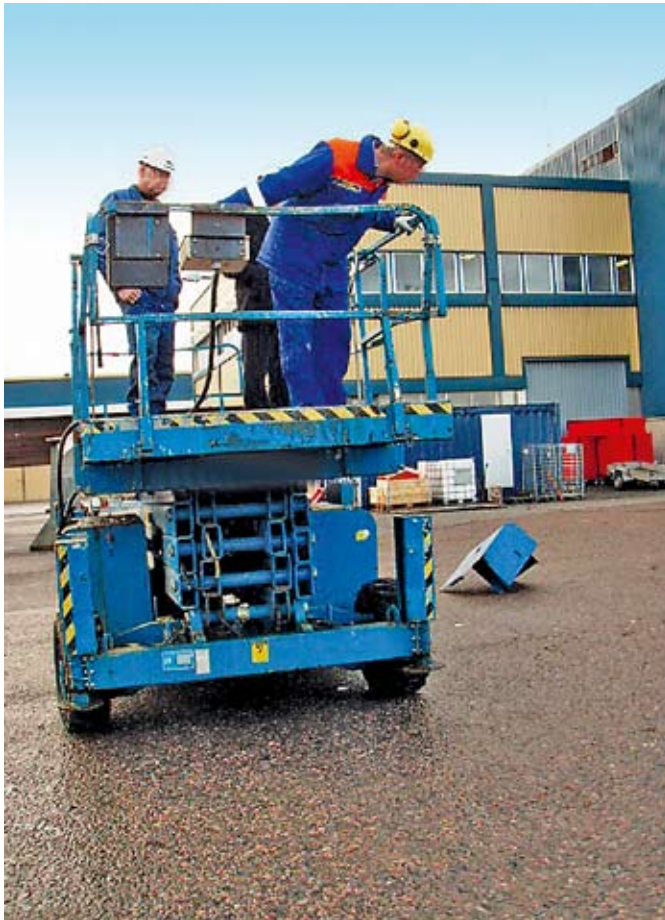
Kuva 2. Lavastettu tilanne tapaturmatilanteesta ja NN:n työasennosta. Huom. NN työskenteli yksin tapaturmahetkellä nostokorissa!
