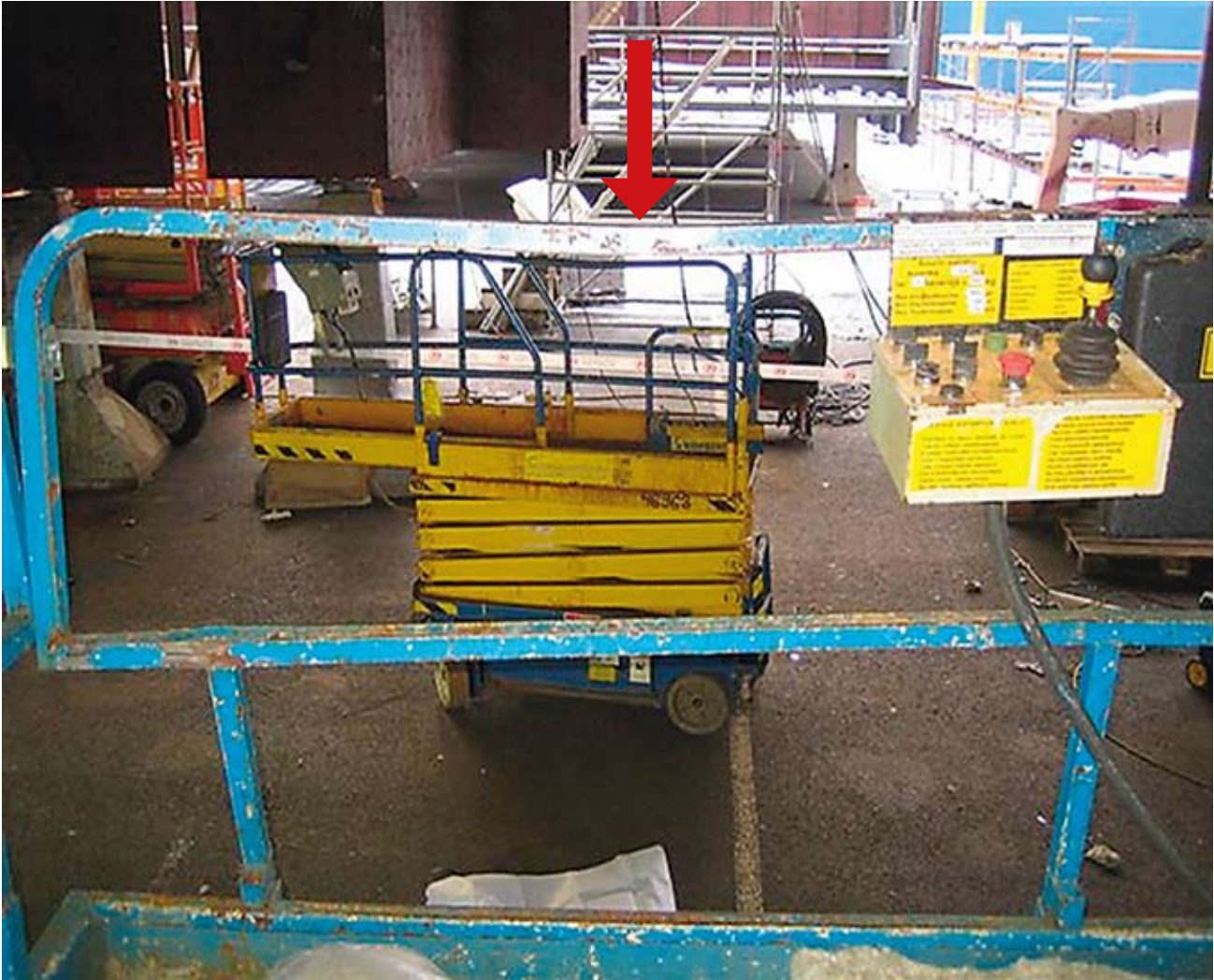
Kuva 3. Kaiteen kohta (nuoli) johon NN puristui. Kuvan oikeassa reunassa on ohjauspaneeli.
