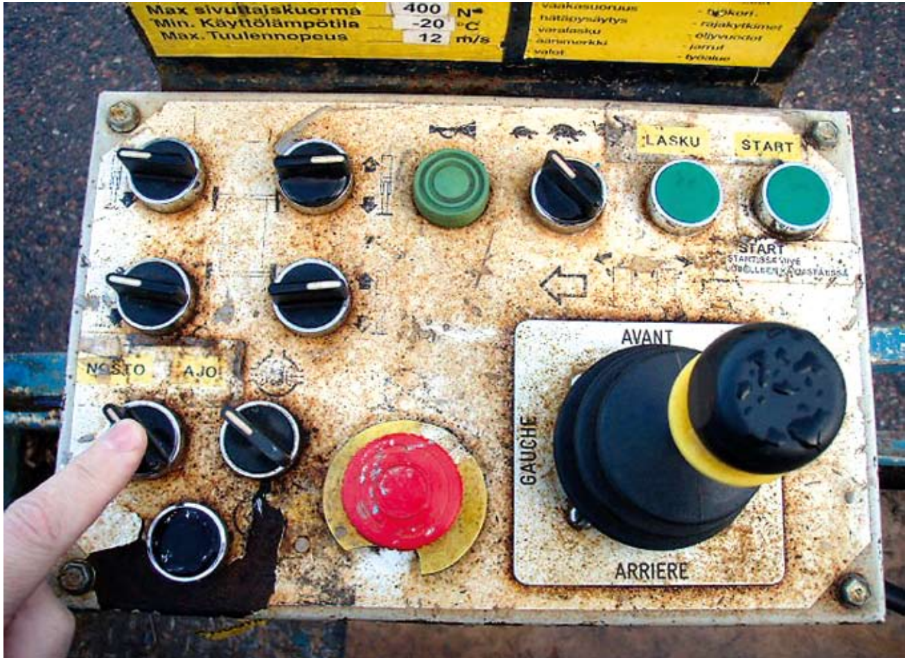
Kuva 1. Ohjauspaneelin vaihtokytkimen asento tapaturmahetkellä. Sormi osoittaa vaihtokytkintä. Oikeassa reunassa nosto- ja ajoliikkeen hallintaelin (joystick). Kuvan asennossa nostokoria voidaan nostaa tai laskea. Kun vaihtokytkintä käännetään myötäpäivään, nostinta voidaan siirtää lattiatasolla.
