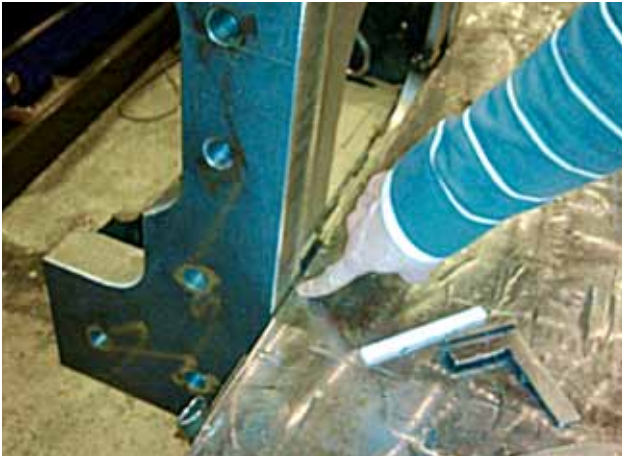
Kuva 2 Sormi osoittaa kohtaa, johon NN:n piti hitsata n. 5 cm pituinen hefti.
