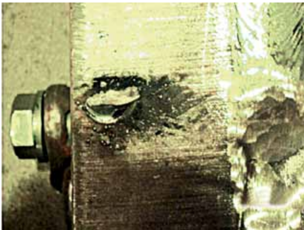
Kuva 3 ja 4 NN:n hitsaamat heftit; kuvassa 3 n. 2cm pituinen hefti ja kuvassa 4 lähes olematon hefti.
