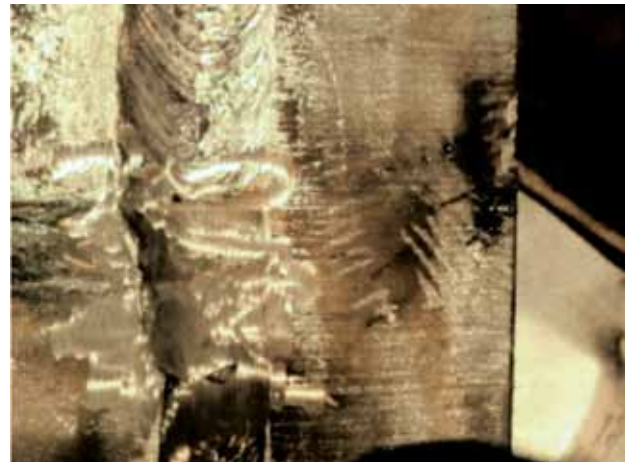
Kuva 3 ja 4 NN:n hitsaamat heftit; kuvassa 3 n. 2cm pituinen hefti ja kuvassa 4 lähes olematon hefti.
