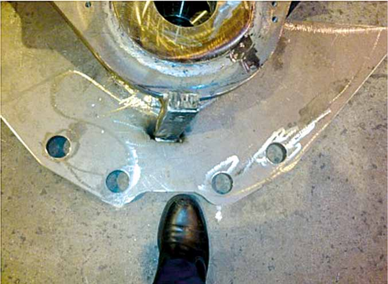
Kuva 1. Kotelon kärki, jonka varaan NN laski kotelon betonilattialle. Mittakaavana on kengän kärki.
