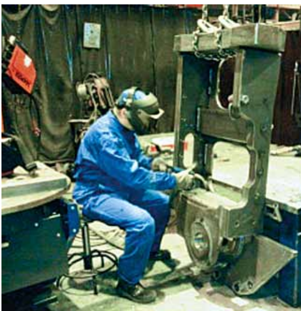
Kuva 5. Lavastettu tilanne NN:n hitsaustyöstä tapaturmahetkellä. Kuvassa henkilö istuu, mutta NN oli tapaturmahetkellä kyykistyneenä. Kuvassa kotelo on kiinni nosturissa, mutta tapaturmahetkellä nosturi oli irrotettu kotelosta.
